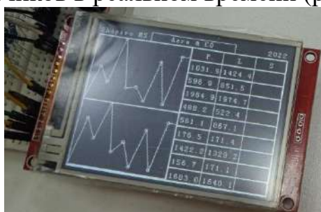
Рисунок 20 - Дисплей выводит информацию с датчиков, строит графики
