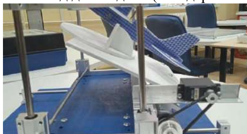
Рисунок 19 - Стенд для модели (Увеличенный угол атаки)
