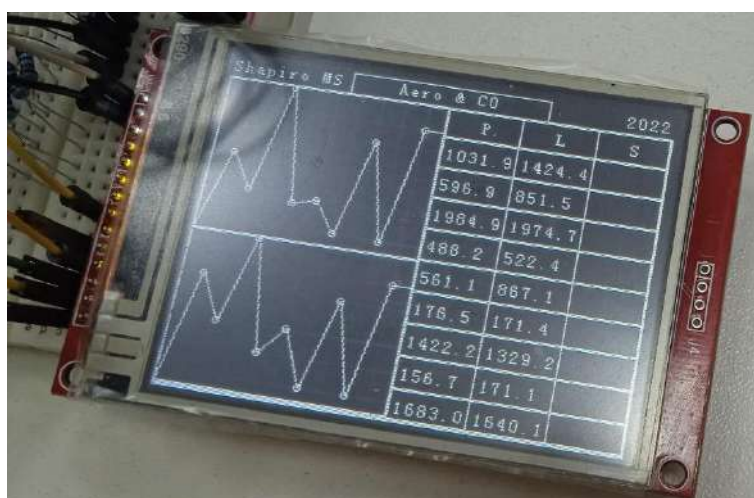
Рисунок 16 - Дисплей выводит информацию с датчиков, строит графики
