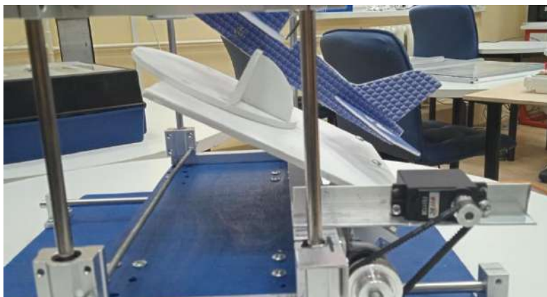
Рисунок 27 - Стенд для модели (Увеличенный угол атаки)
