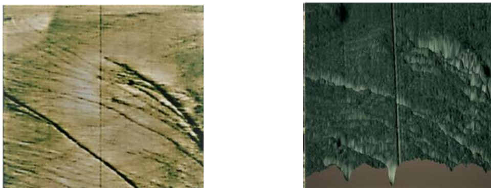
Рисунок 2 – 2D и 3D изображения поверхности монокристалла кремния.
