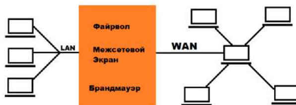
Рисунок 4 - Принцип работы межсетевого экрана
