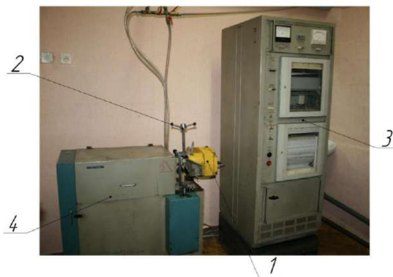
Рисунок 5 – Машина трения 2070 СМТ-1 для проведения испытаний на изнашивание: 1 – испытательная камера; 2 – механизм нагружения; 3 – блок для сбора информации; 4 – корпус машины трения
