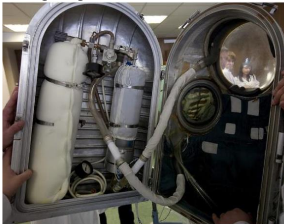
Рисунок 2 – Внутреннее устройство системы жизнеобеспечения
