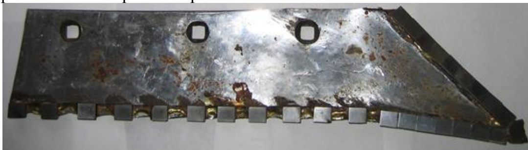
Рисунок 1 – Керамические элементы на фронте лемеха
