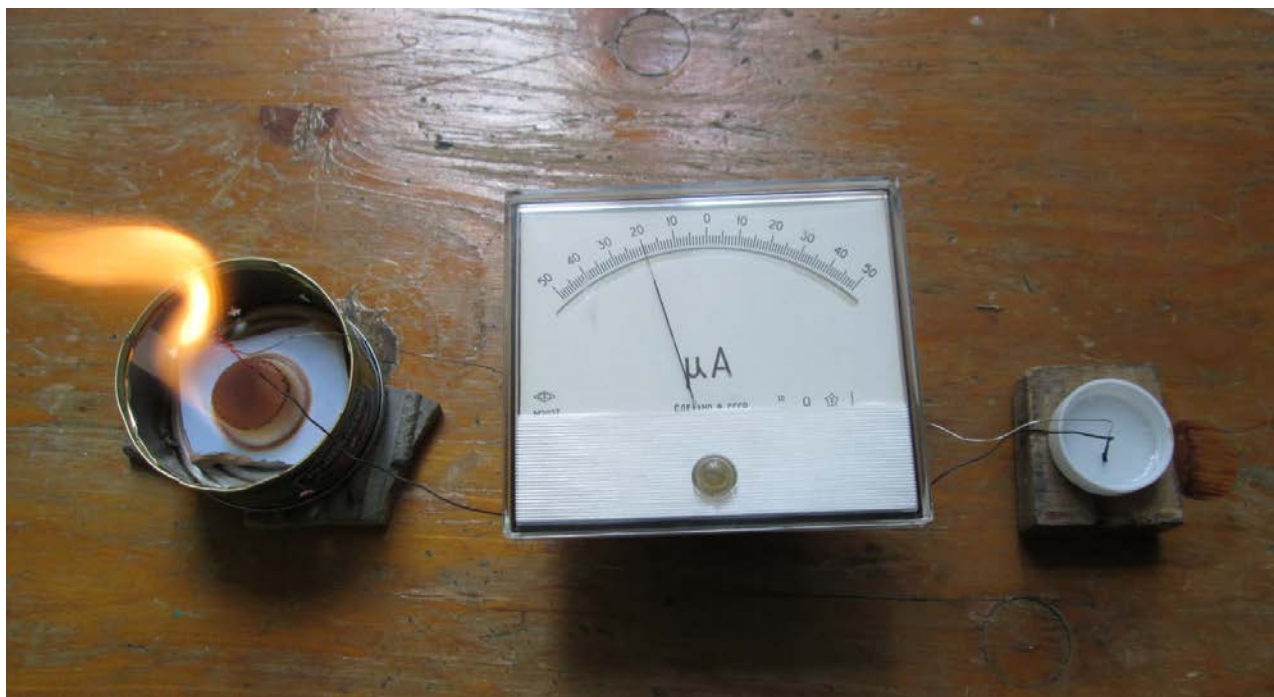
Рис. 2 Демонстрация работы нихромконстантановой термопары
