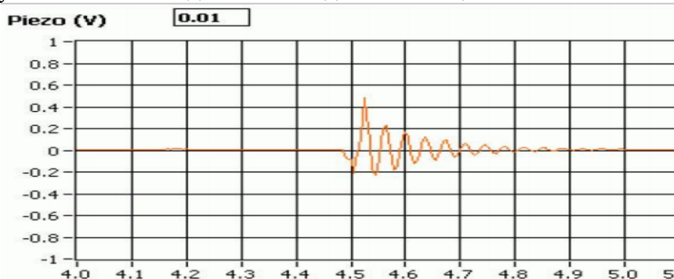
Рисунок 1. Реакция пьезодатчика на единичный щелчок
