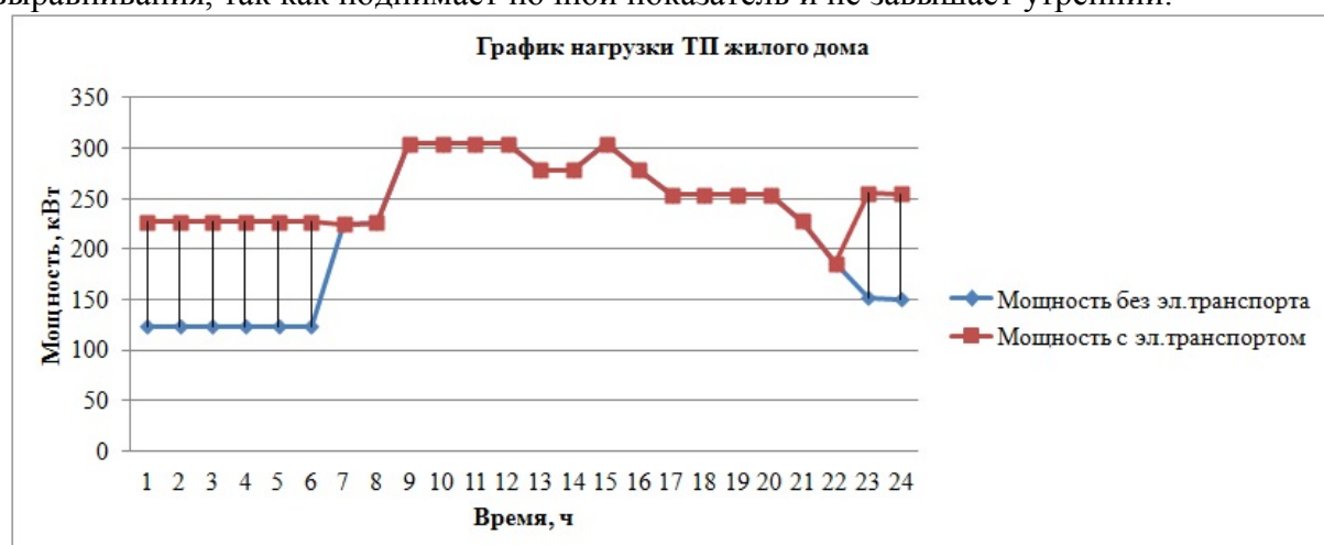
Рисунок 1 – График нагрузки ТП жилого дома
