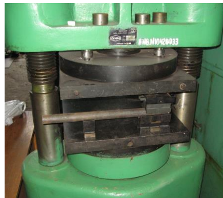
Рисунок 3 – Трехмерная модель технологической оснастки и внешний вид приспособления, установленного на опорную плиту пресса П–125
