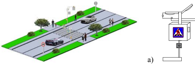
Рисунок 15 – Визуализация впервые разработанной системы повышения безопасности передвижения пешеходов по нерегулируемому ПП:
