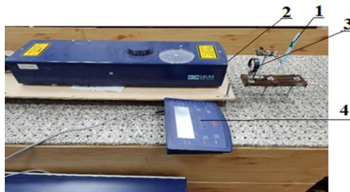
Рисунок 1 – Общий вид устройства упрочнения скальпеля импульсным лазером, где 1 — скальпель, 2 — импульсный лазер, 3 — линза, 4 — пульт управления.
