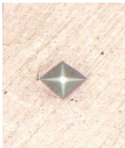
Рисунок 9 – Характеристика слоя стали 40X13 образца по отпечаткам алмазной пирамиды
