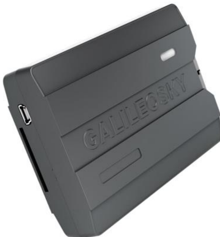
Рисунок 4.17 – Устройство считывания и запоминания данных CAN-шины автомобиля GALILEOSKY 7.0
