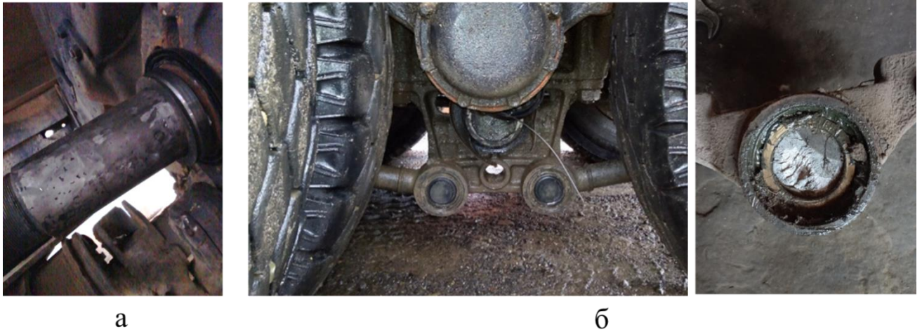
Рисунок 1.9 – Повреждения оси балансирной подвески: а – износ рабочей поверхности; б – разрушение оси балансира
