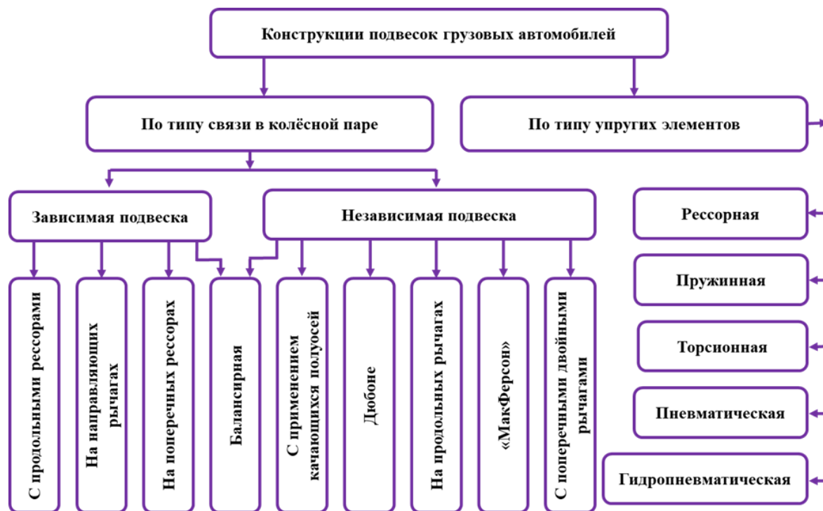
Рисунок 1.1 – Варианты конструкций подвесок грузовых автомобилей
