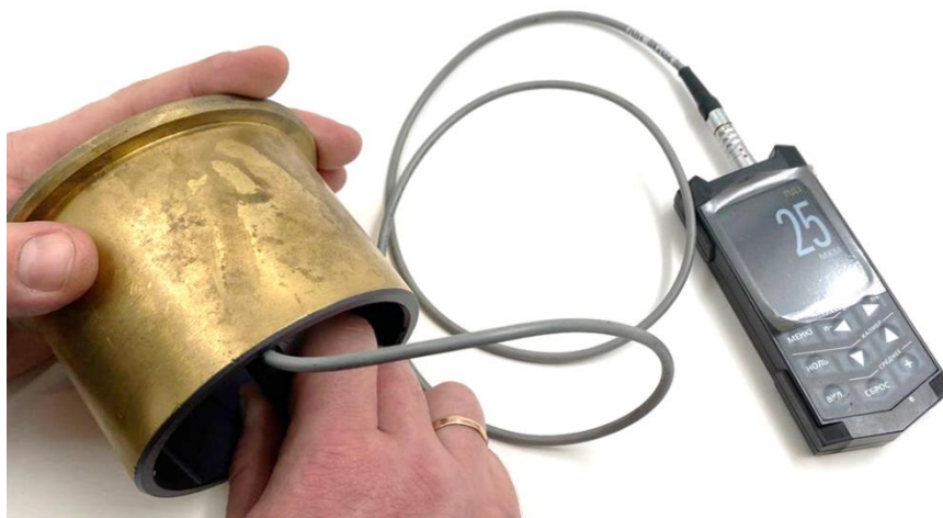
Рисунок 4.35 – Промежуточный контроль толщины твердосмазочного антифрикционного покрытия
