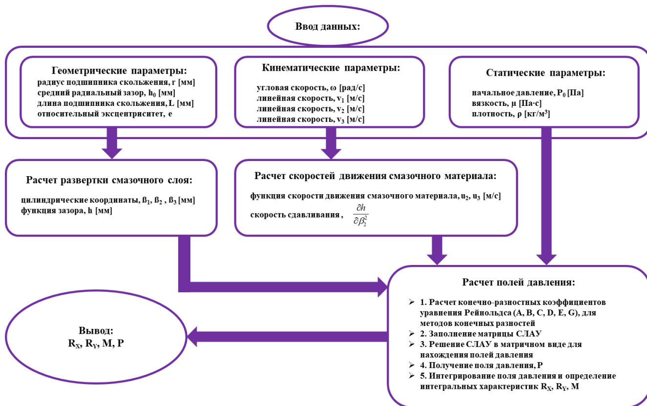
Рисунок 2.8 – Алгоритм расчета подшипника скольжения
