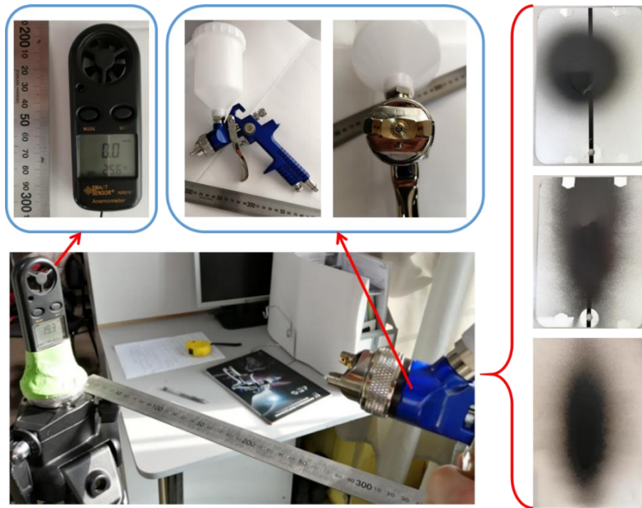
Рисунок 4.3 – Процесс измерения скорости воздушного потока
