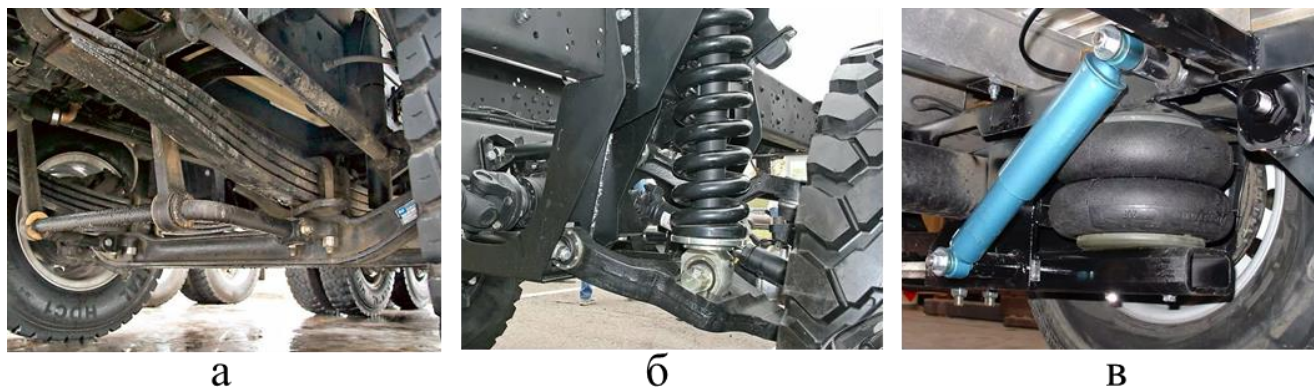
Рисунок 1.2 – Конструкции подвесок грузовых автомобилей по типу используемых упругих элементов: а – рессорная; б – пружинная; в – пневматическая
