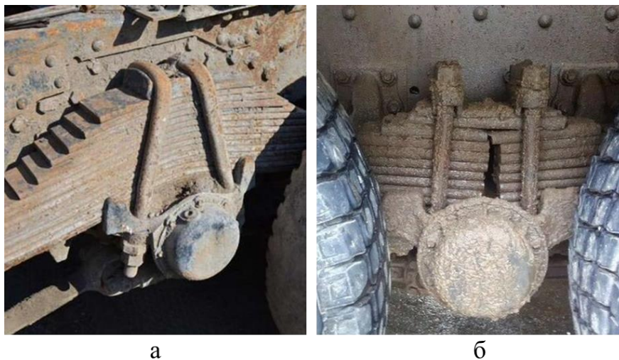
Рисунок 1.7 – Повреждения рессоры балансирной подвески: а – деформация; б – разрушение
