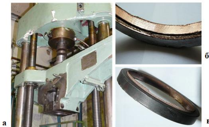
Рисунок 3.4 – Испытания на разрывной машины ГМС – 50: а – процесс испытаний; б, в – образцы после испытания
