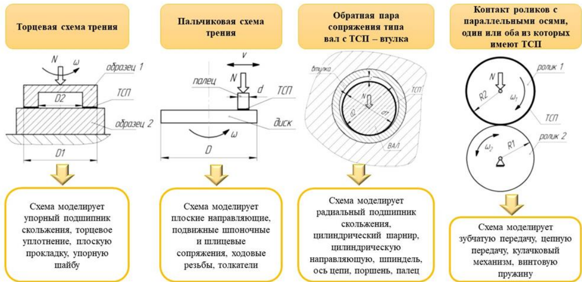
Рисунок 4.21 – Схемы трибологических испытаний с использованием твердосмазочных антифрикционных покрытий
