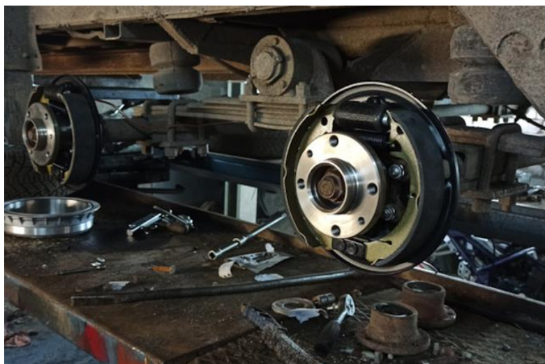
Рисунок 1.4 – Конструкция балансирной подвески прицепа автовоза
