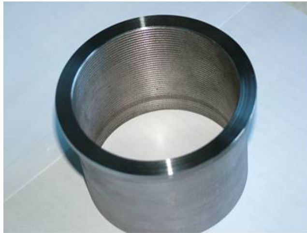
Рисунок 3.1 – Стальная основа с предварительно обработанной поверхностью
