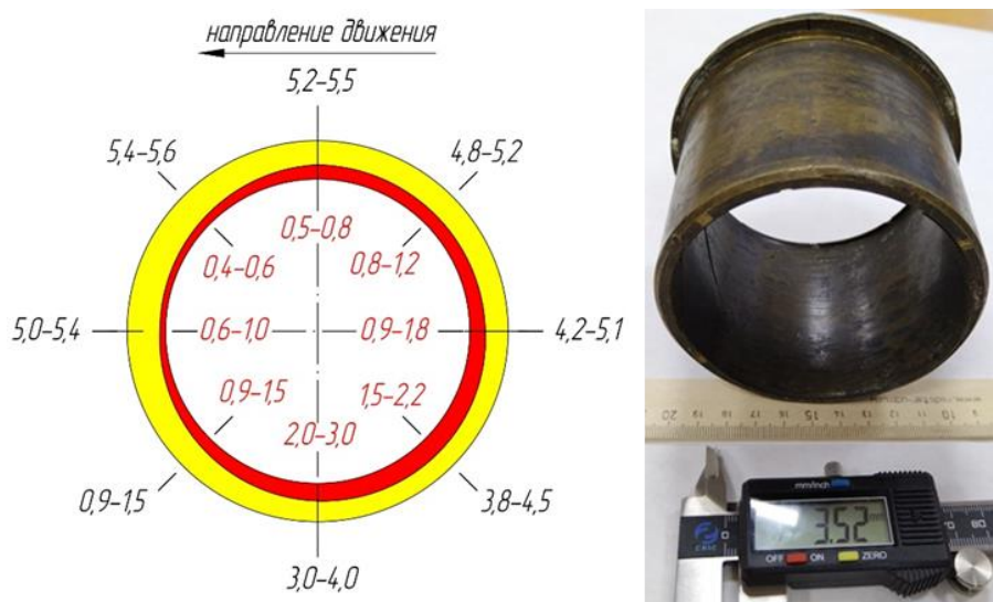
Рисунок 1.28 – Пространственное распределение износа на рабочей поверхности подшипника скольжения (локализованное ускоренное изнашивание)
