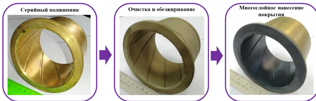
Рисунок 4.34 – Этапы нанесения твердосмазочного антифрикционного покрытия
