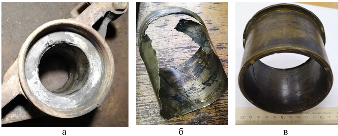
Рисунок 1.6 – Повреждения втулок (подшипников скольжения): а – башмак балансира с разрушенной втулкой; б – разрушение втулки; в – износ втулки
