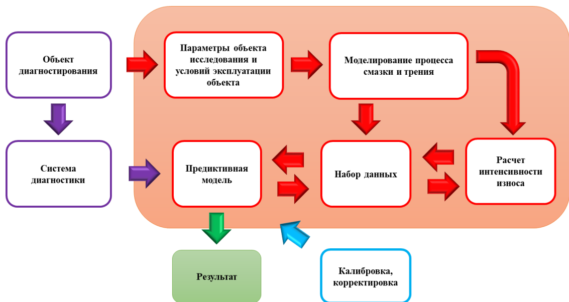
Рисунок 2.1 – Структурная схема теоретического обоснования процессов смазки и изнашивания подшипников скольжения балансирной подвески
