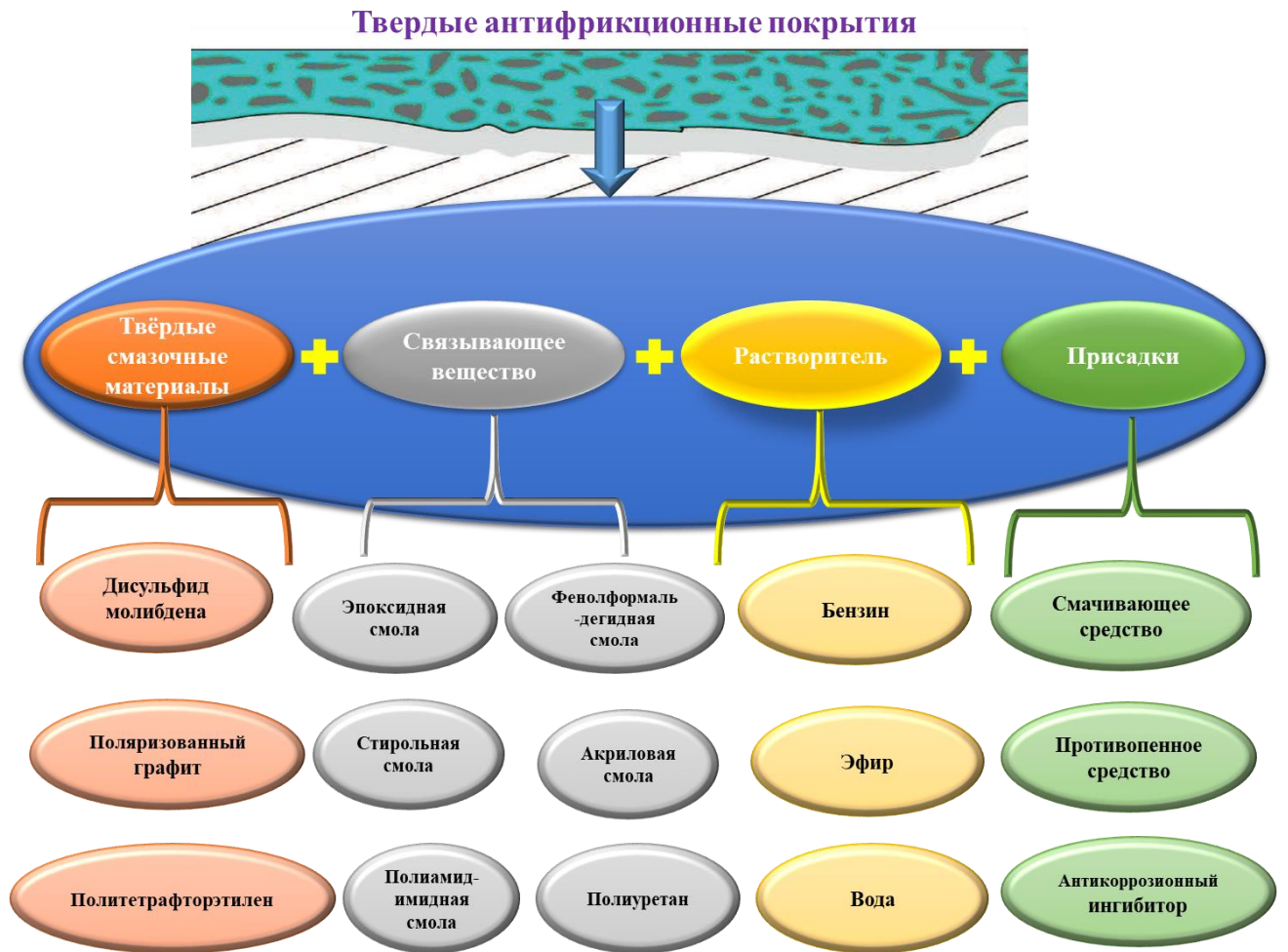
Рисунок 4.1 – Состав твердосмазочного антифрикционного покрытия
