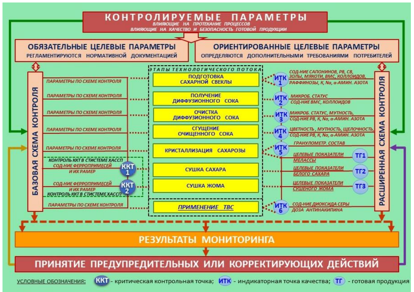
Рисунок 23 – Структурная схема мониторинга технологического потока производства белого свекловичного сахара для обеспечения качества и безопасности продукции
