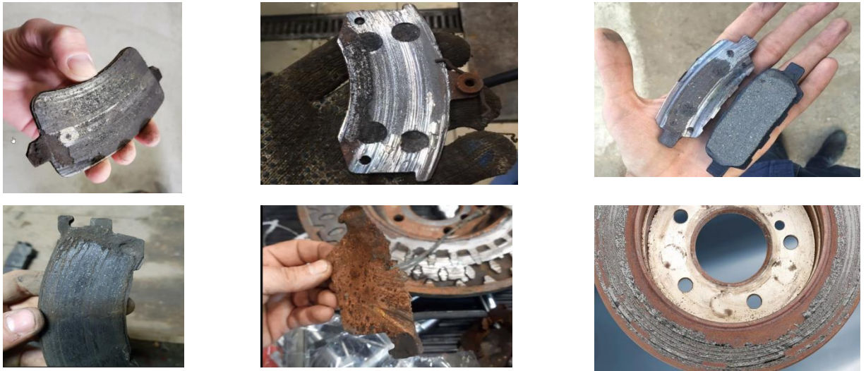
Рисунок 1.8 – элементы ТормС в эксплуатации с неправильной оценкой остаточного ресурса
