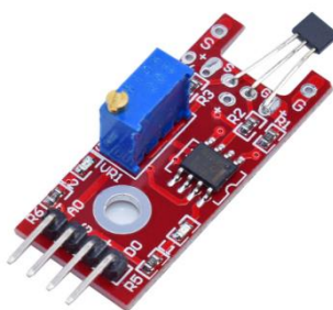
Рисунок 3.13 – Модуль KY-24 с датчиком холла
