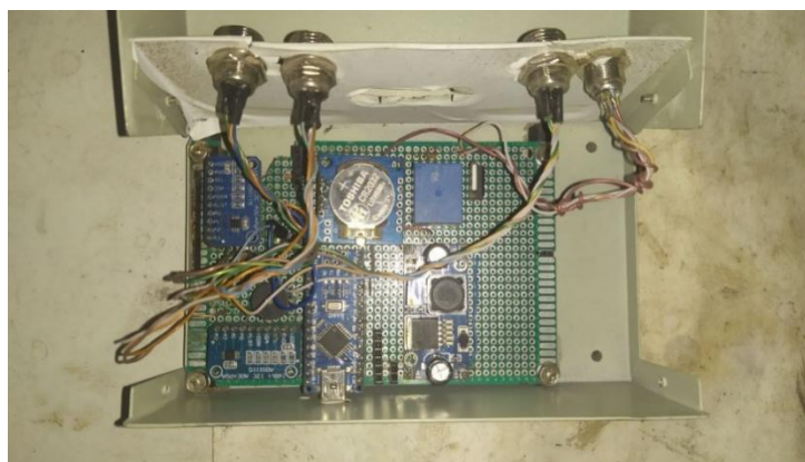
Рисунок 3.22 – Электронный блок программно-технического КСД
