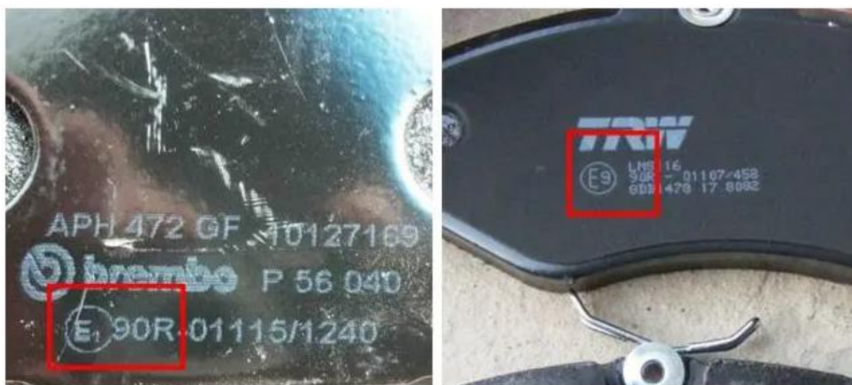
Рисунок 2.18 – Пример маркировки соответствия стандарту ECE R-90
