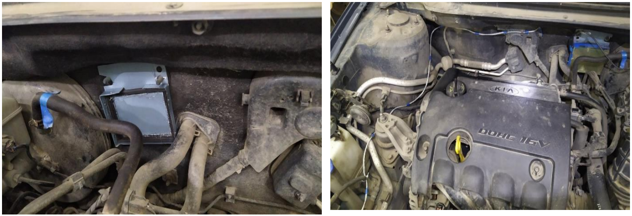
Рисунок 3.24 – Месторасположение блока КСД в автомобиле
