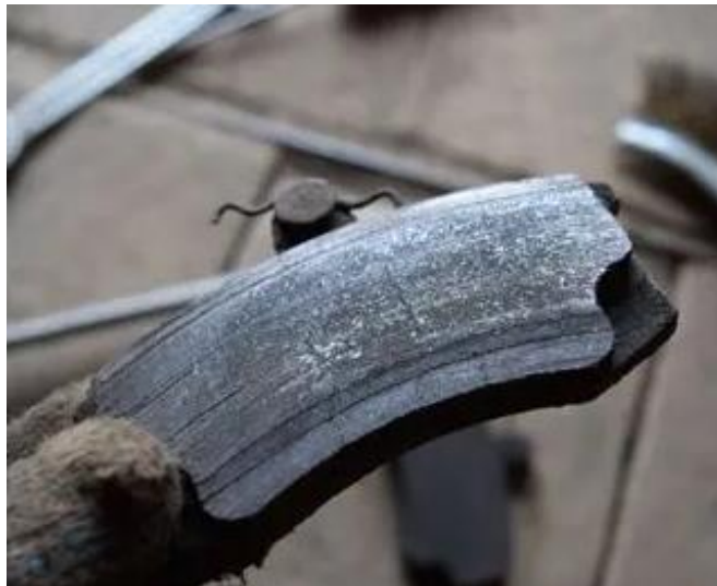
Рисунок 2.13 – Металлические тормозные колодки
