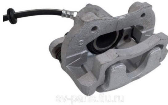
Рисунок 2.9 – Тормозной суппорт тормозного механизма с плавающей скобой
