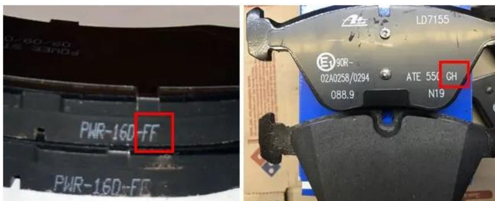
Рисунок 2.17 – Маркировка коэффициента трения сертифицированных в РФ тормозных колодок
