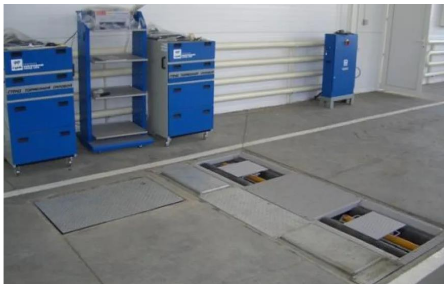
Рисунок 2.4 – Роликовый тормозной стенд
