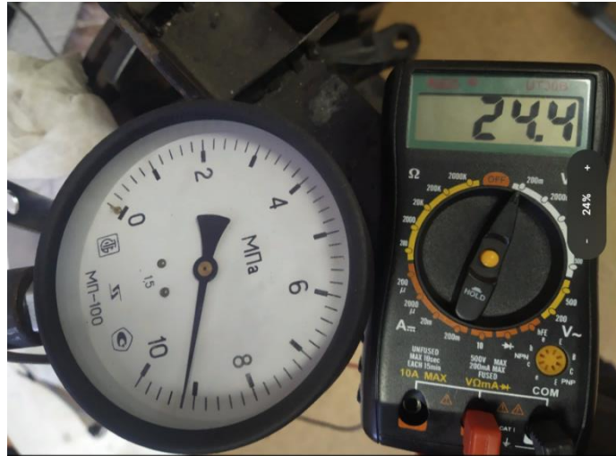
Рисунок 3.20 – Оценка давления тормозной жидкости с помощью мультиметра.
