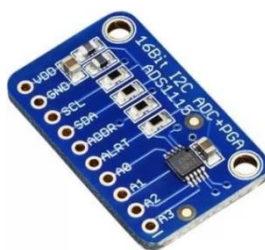
Рисунок 3.10 – Внешний вид модуля ADS1115
