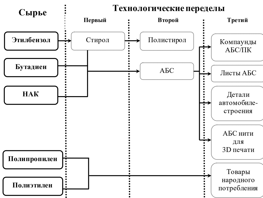
Рис. 3.3. Принципиальная схема технологических потоков АО «Пластик»
