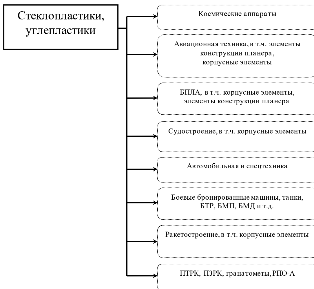
Рис.2.14. Области применения стеклопластиков и углепластиков в оборонных целях
