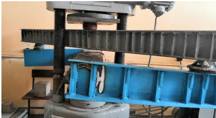
Рисунок 2 - Процесс испытания балки
