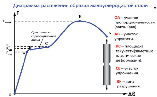
Рис. 2. Диаграмма растяжения образца из малоуглеродистой стали.
