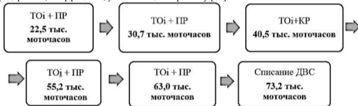
Рисунок 3 - Периодичность проведения ремонтов двигателей MTU DD16V4000 карьерного самосвала БЕЛАЗ-75309
