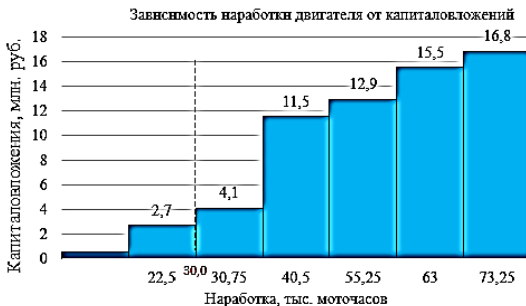
Рисунок 2 - Зависимость ресурса двигателя от капиталовложений MTU DD16V4000 карьерного самосвала БЕЛАЗ-75309
