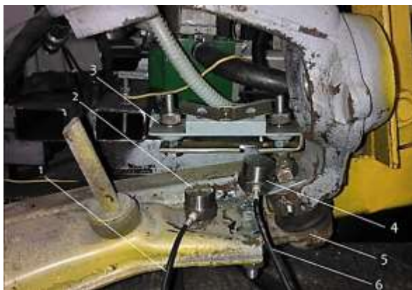
Рисунок 6 – Схема размещения вибродатчиков для диагностирования элементов подвески легкового автомобиля: 1 – сигнальный кабель дополнительного вибродатчика; 2 – дополнительный вибродатчик; 3 – кронштейн установки индикатора для определения осевого зазора в шарнирном соединении механическим способом; 4 – основной вибродатчик; 5 – исследуемый элемент – шаровый шарнир; 6 – сигнальный кабель основного вибродатчика
