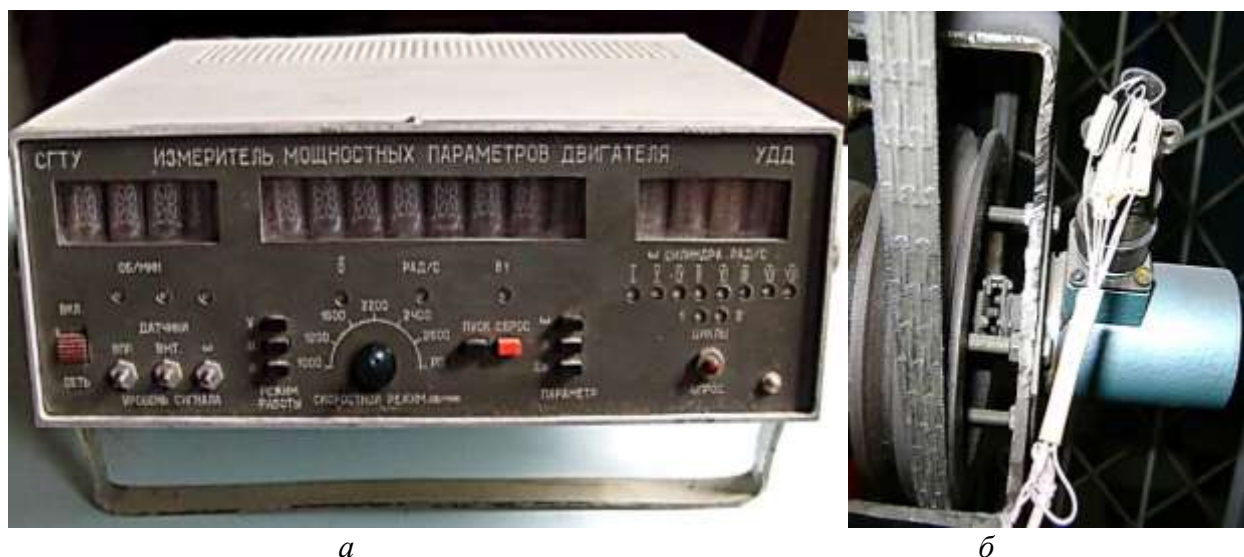
Рисунок 4 - Устройство диагностирования элементов ГРМ ДВС (а) и энкодер BE-178A (б)
