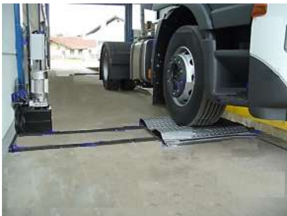
Рисунок 7 – Испытание автомобиля с использованием специализированного диагностического стенда
