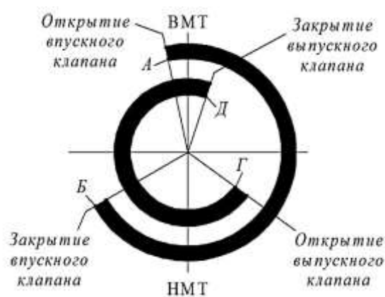
Рисунок 3 - Фазы газораспределения 4Ч 9,2/9,2: А=12°; Б=60°; Г=54°; Д=18°
