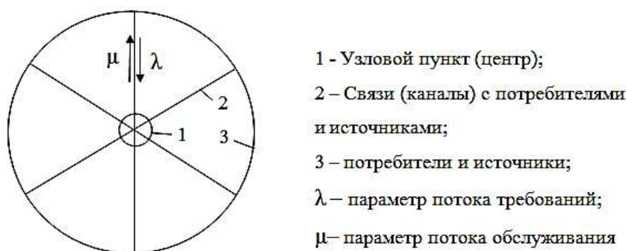
Рисунок 3 – Концептуальная схема использования принципа «хаб»
