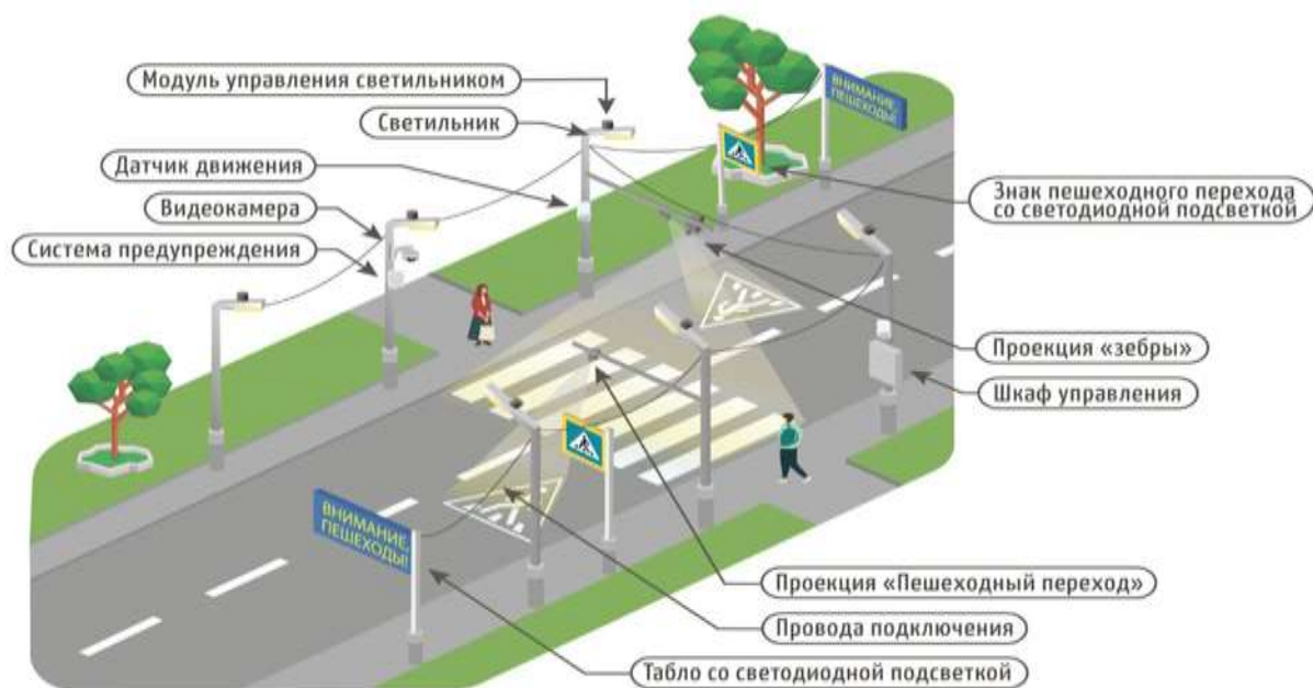
Рисунок 7 – Система управления движением на нерегулируемом ПП
