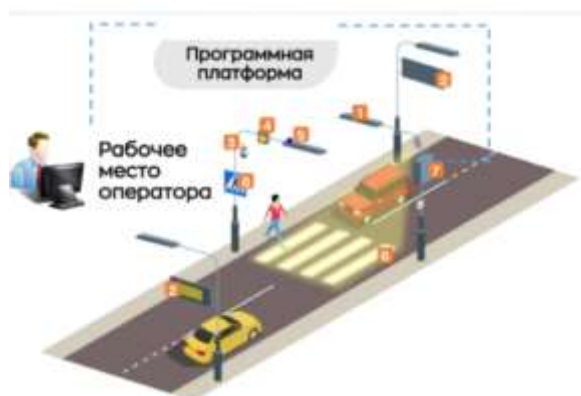
Рисунок 9 – Программная платформа для системы управления движением на нерегулируемом ПП
