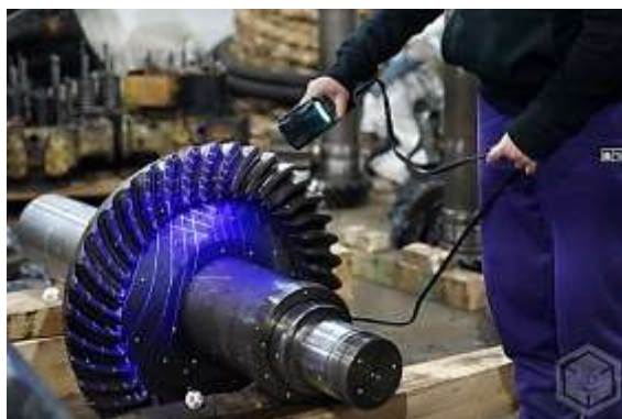
Рисунок 4 – Реверс-инжиниринг ВРК морского буксира
