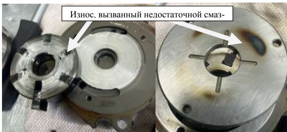
Рисунок 6 – Износ подкачивающего насоса ТНВД вследствие использования дизельного топлива с малой смазывающей способностью
