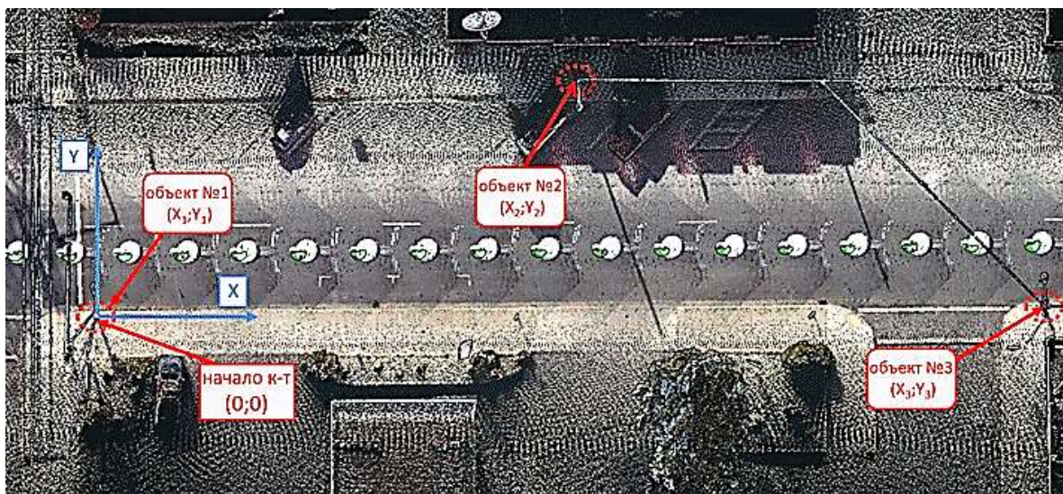
Рисунок 5 – Фрагмент облака точек отсканированной автомобильной дороги, приведенного в декартову систему координат
