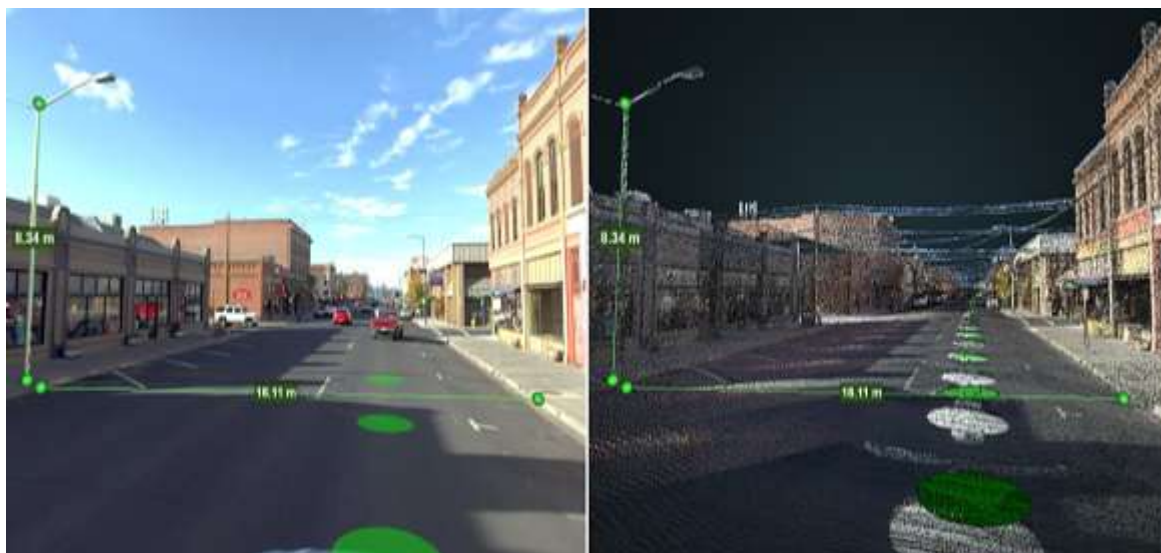
Рисунок 4 – Совмещение облака точек с фото-видеоматериалом
