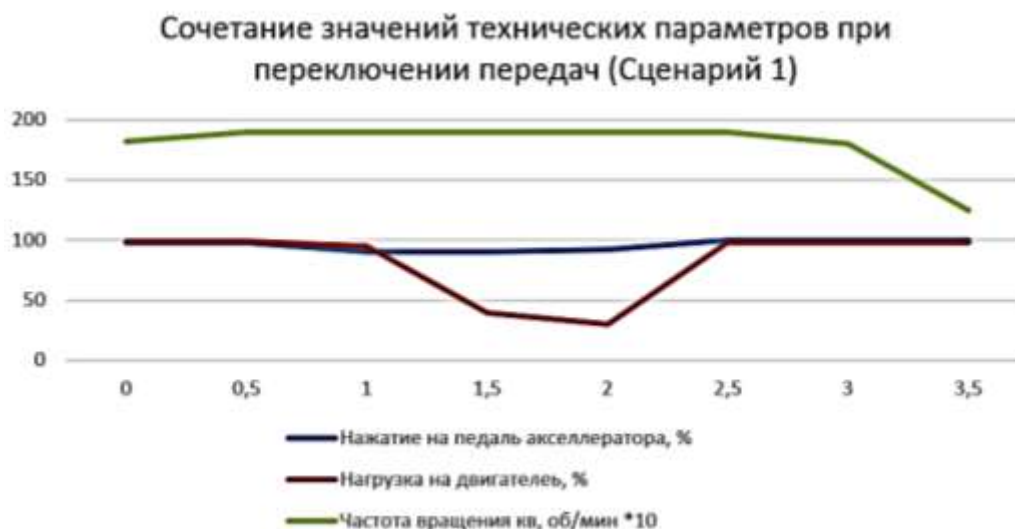
Рисунок 2 - Значение технических параметров работы двигателя при сценарии переключения передач №1
