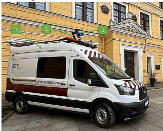
Рисунок 3 – Передвижная дорожно-транспортная лаборатория с лазерным сканирующим устройством: 1- базовая лаборатория с измерительным комплексом КП-514 RDT; 2 – двухосный гироскопический стабилизатор; 3 – лазерное сканирующее устройство
