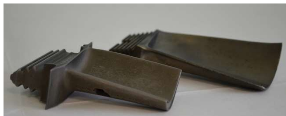
Рисунок 1 – Рабочие лопатки турбины авиационного двигателя с продольными охлаждающими отверстиями переменного сечения
