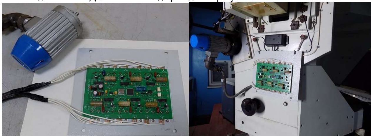
Рисунок 8 – Внешний вид силового привода для ШД-5
