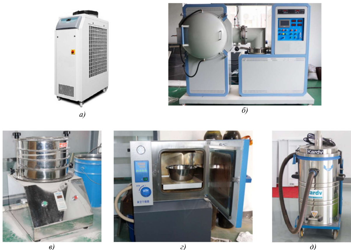
Рисунок 1 – Вспомогательное оборудование для 3D-печати металлом:
