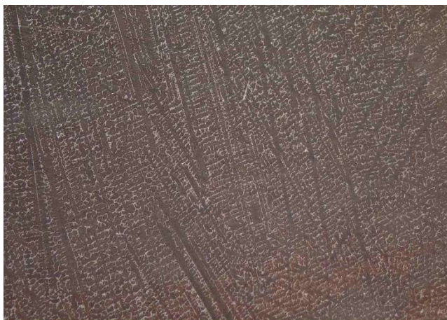
Рисунок 1 – Структура литого слитка из сплава 131 (увеличение x100)
