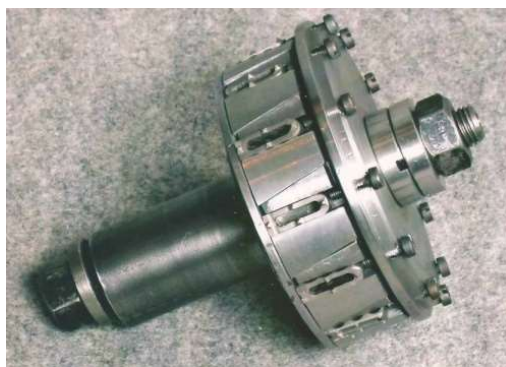
Рисунок 3 – Устройство для реализации серийного производства имплантов для PLIF вдоль поперечной оси изделия
