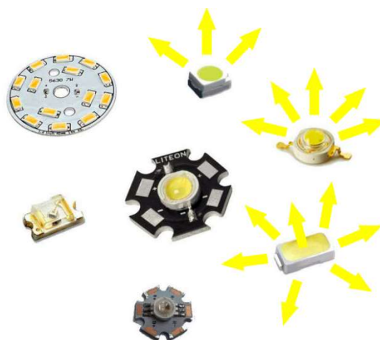
Рисунок 2 - Различные варианты светодиодов
