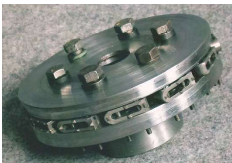
Рисунок 1 – Устройство для реализации технологии серийного производства имплантов для PLIF вдоль продольной оси изделия
