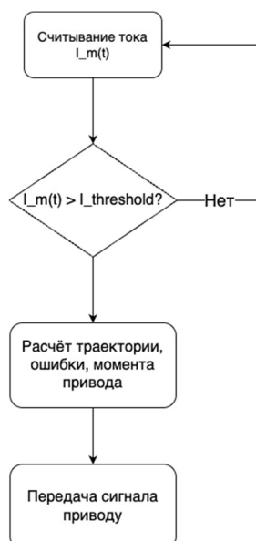
Рисунок 1 – Блок-схема адаптивного алгоритма управления
