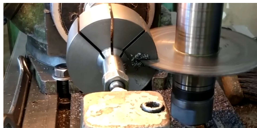
Рисунок 6 – Разрезка цилиндра на вертикально-фрезерной операции
