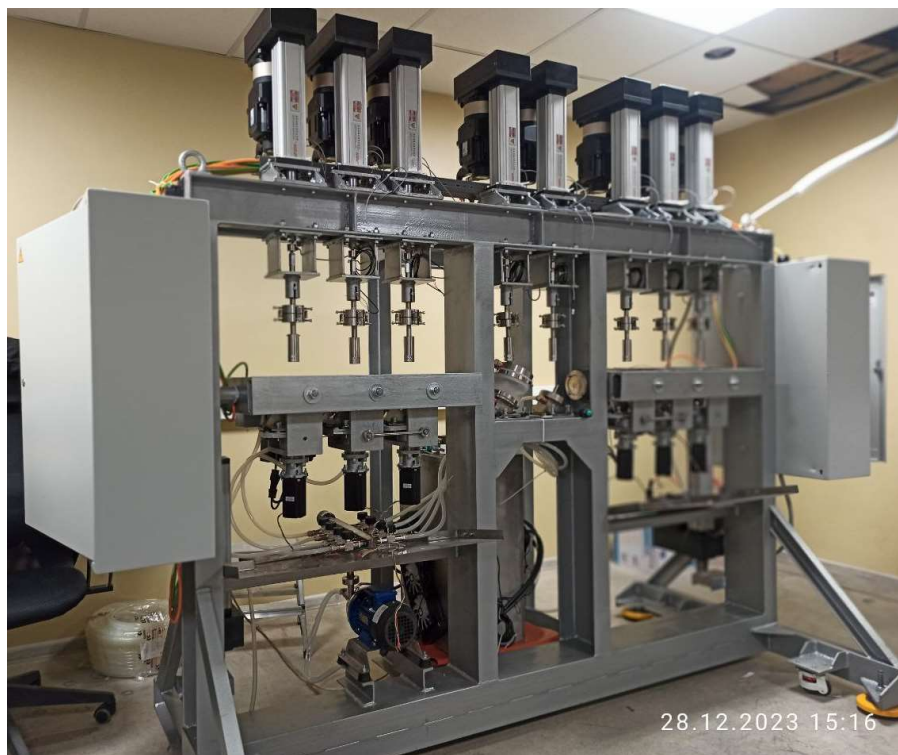
Рисунок 7 – Общий вид изготовленного МСС для испытания ТЭТБС на износ
