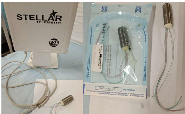
Рисунок 1 – Глубоководные имплантируемые датчики фирмы «Stellar telemetry receiver» в комплекте со специальным приёмным устройством (антенной)
