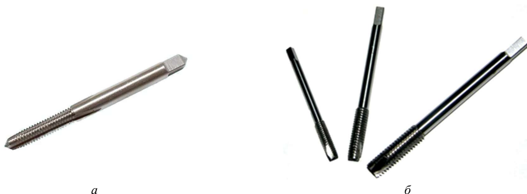
Рисунок 8 – Конструкции пластически-деформирующего (а) метчика (ПДМ) и режуще-деформирующих (б) метчиков (РДМ)
