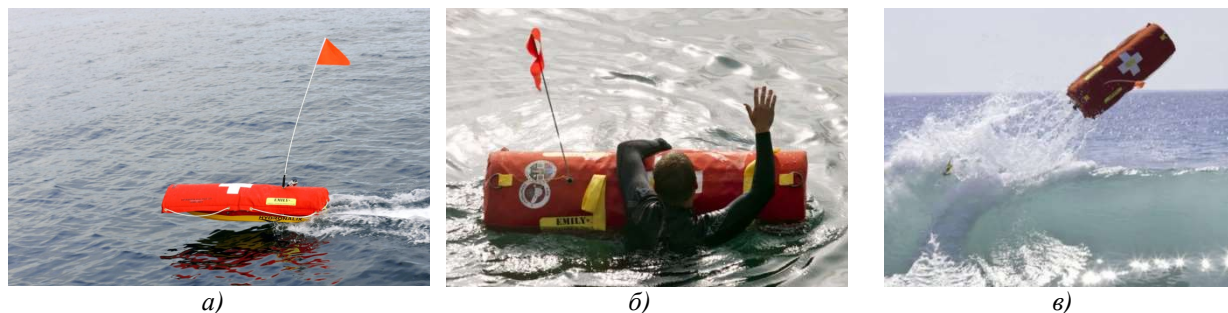
Рисунок 4 – Дистанционно управляемое роботизированное средство «EMILY»:
