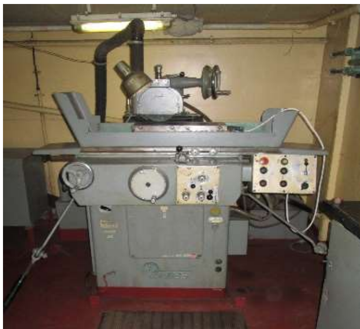
Рисунок 1 – Общий вид установленного на фундаментах и растяжках плоскошлифовального станка SPC-20c механообрабатывающего участка плавучей мастерской
