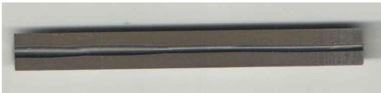
Рисунок 1 – Износ канала фокусирующей трубки сопла гидроабразивной установки
