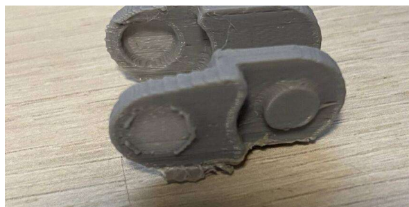
Рисунок 2 – Пример дефекта печати вызванный: высокой температурой, большим значением толщины слоя, пропусками шагового двигателя, переэкструзией (фото авторов)
