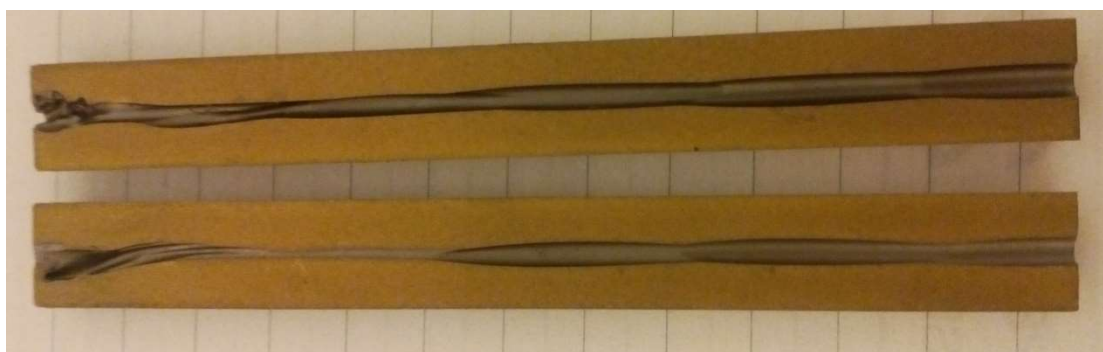
Рисунок 3 - Износ канала фокусирующей трубки при использовании абразива из карбида кремния
