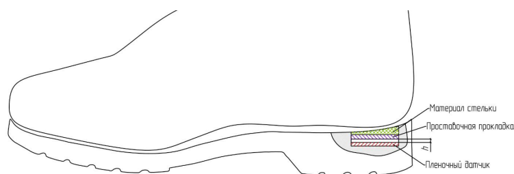
Рисунок 4 – Вид сбоку модуля сбора информации
