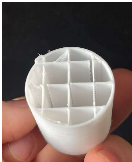
Рисунок 4 – Пример дефекта печати вызванный: неправильным выбором заполнения, большой скоростью ретракта, недостаточным процентом перекрытия стенок (фото авторов)
