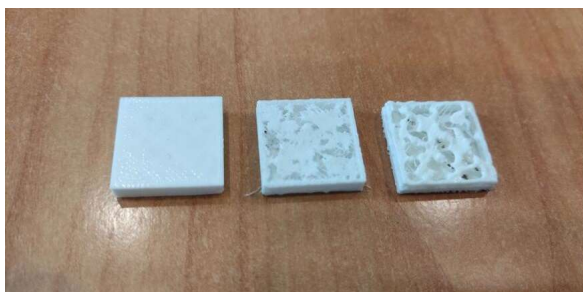
Рисунок 1 – Пример дефекта печати вызванный: недоэкструзией, зажевыванием эластомера, высокой скоростью ретрактов (фото авторов)
