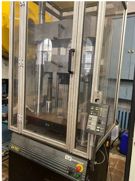
Рисунок 3 – Испытательная машина Instron 600DX-F1-G1
