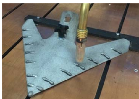
Рисунок 5 – Наплавленная лапа культиватора
