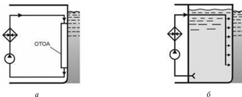
Рисунок 1 – Схемы обшивочных теплообменных аппаратов: а – лабиринтного типа; б – струйного типа
