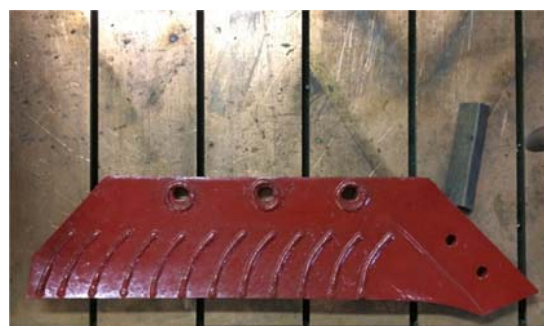
Рисунок 6 – Наплавленный плужный лемех
