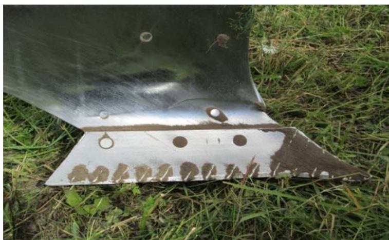
Рисунок 1 – Формирование застойных зон контактного слоя почвы на рабочей поверхности плужного лемеха
