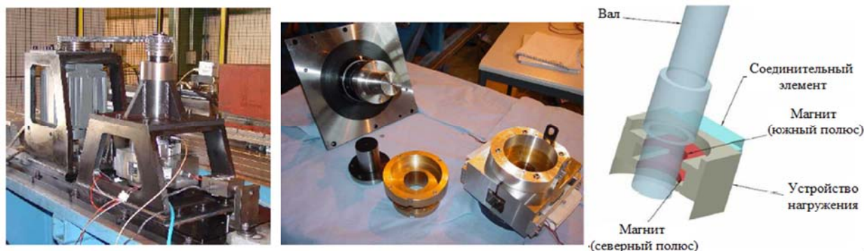
Рисунок 6 – Фото и схема экспериментального подшипникового узла
