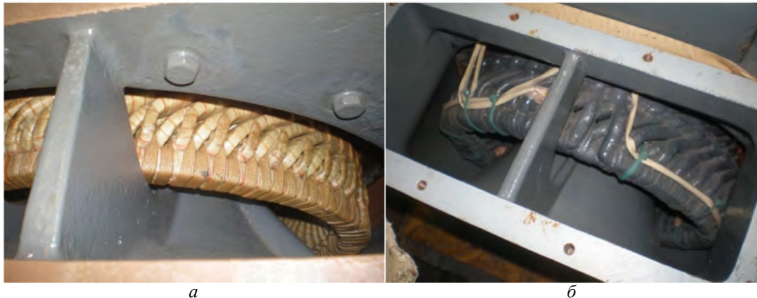
Рисунок 6 – Результаты внешнего осмотра образцов с классом изоляции 220° после испытаний: а – образец № 1 с классом изоляции 220°, б – образец № 2 с классом изоляции 220°
