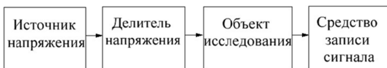
Рисунок 3 – Структурная схема стенда для проведения исследований
