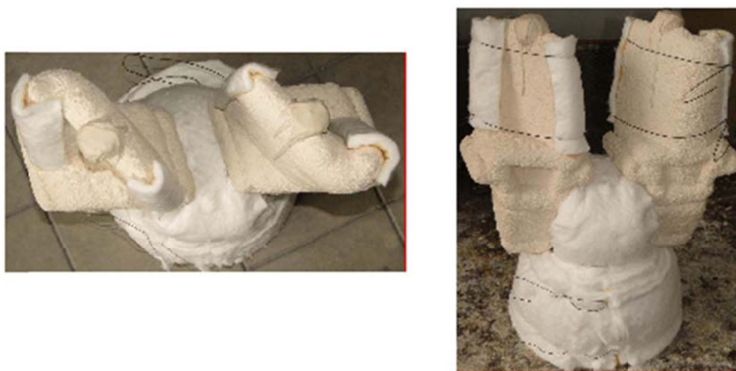
Рисунок 4 – Схема обмотки керамической формы войлоком
