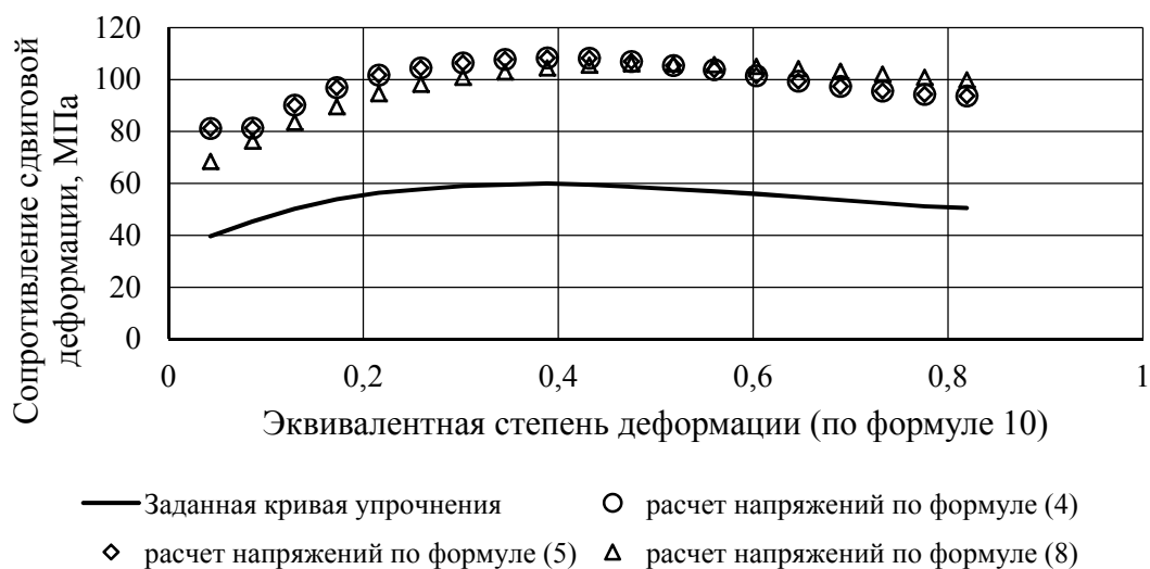
Рисунок 4 – Напряжения сдвига для цилиндрического образца, 900°C
