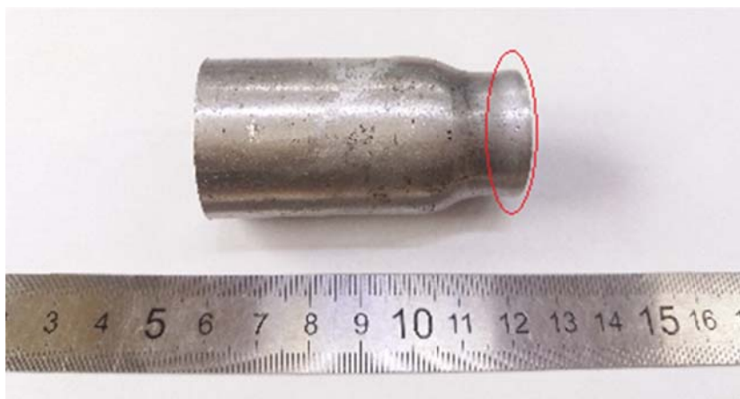
Рисунок 1 – Искривление краевого участка заготовки при обжиге
