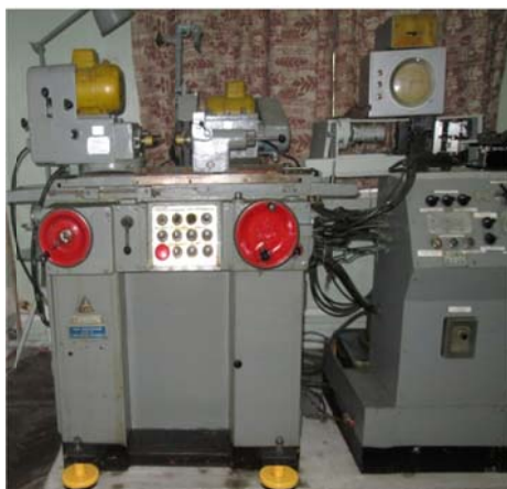
Рисунок 4 – Круглошлифовальный станок BUA 16 на виброизолирующих опорах новой конструкции (патент UA 36389)
