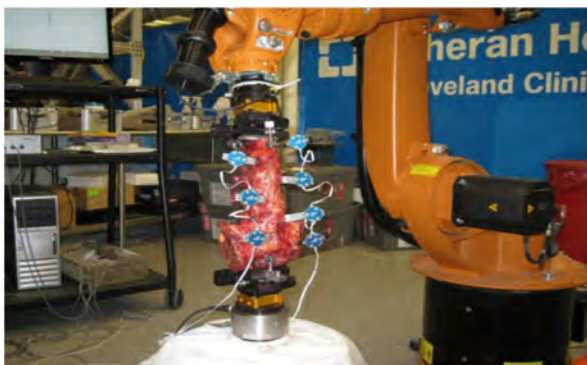
Рисунок 3 – Моделирующее устройство для биомеханических исследований позвоночника и испытаний искусственных межпозвонковых дисков и систем фиксации позвоночника на основе робота KUKA, KR 16 (Augsburg, Germany)
