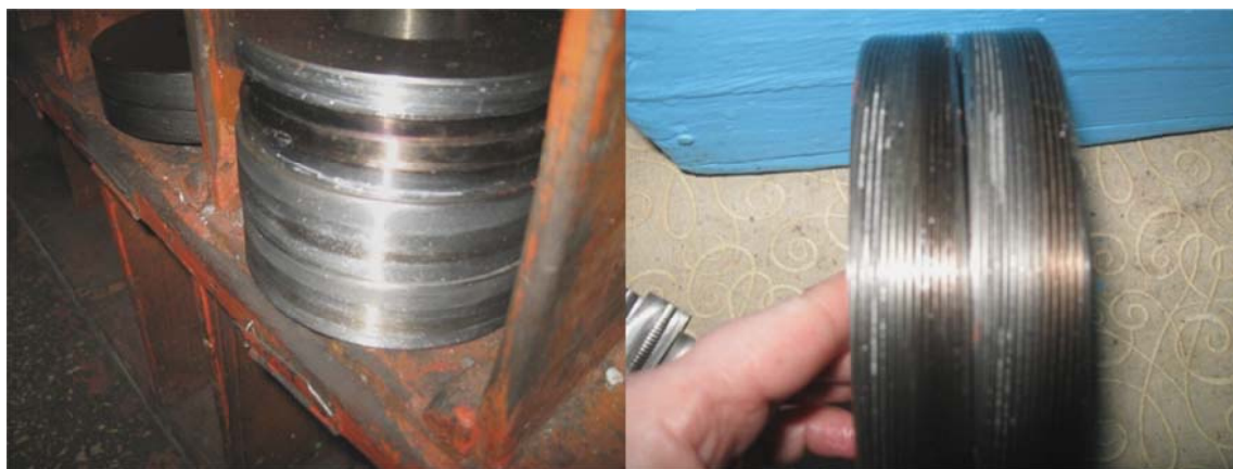
Рисунок 1 – Резьбонакатные ролики со следами повреждений и разрушений рабочих поверхностей в процессе эксплуатации
