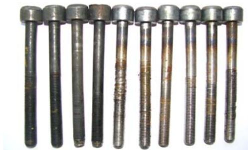
Рисунок 2 – Типичные примеры различных видов брака наружной резьбы, вызванных взаимосвязанными отказами в процессе резьбонакатывания
