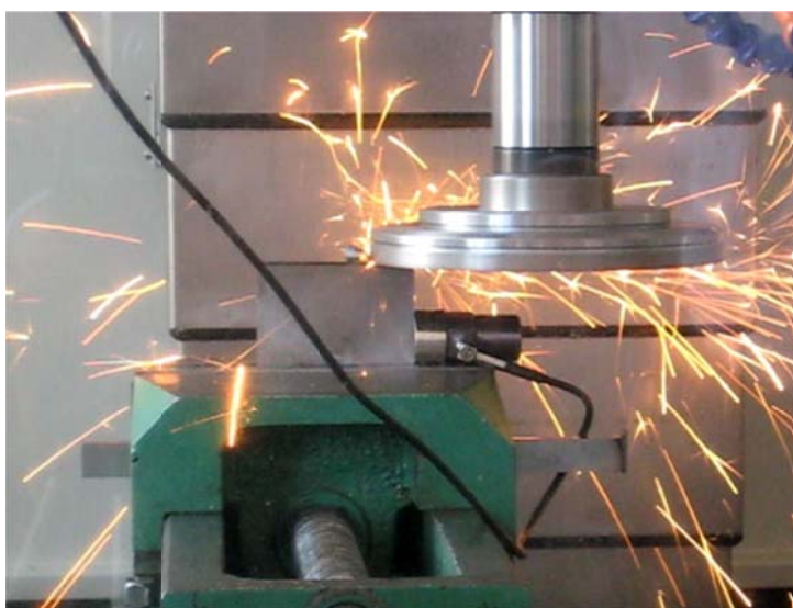
Рисунок 1 – Процесс термофрикционной обработки металлов
