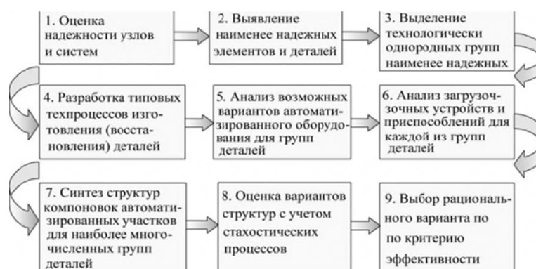
Рисунок 1 – Укрупненная структурная схема последовательности решения задач синтеза автоматизированных участков ремонтного производства
