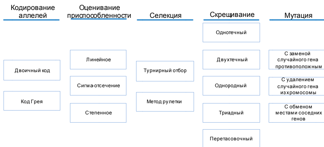
Рисунок 2 – Схема методов реализации этапов генетического алгоритма
