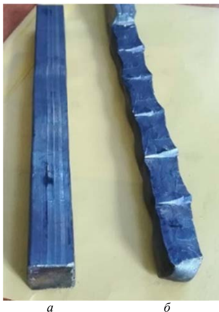
Рисунок 3 – Исходная заготовки сечением 20,5x20,5 мм (а) и полученная поковка сечением 15x15 мм (б)
