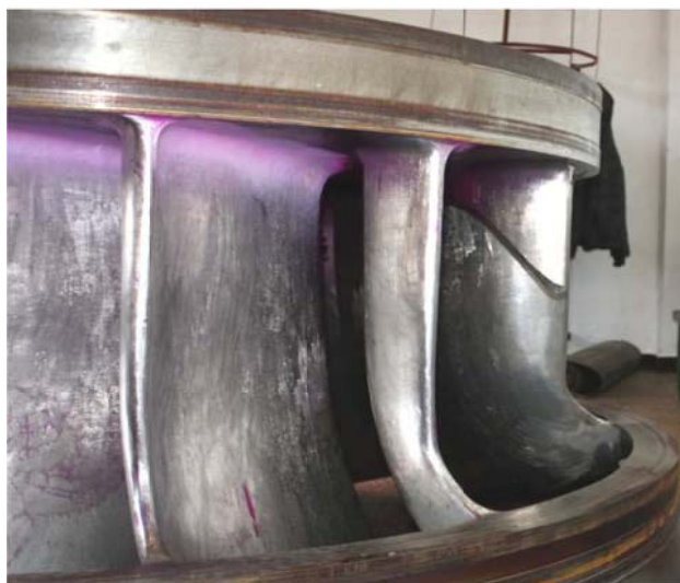
Рисунок 2 – Сценарии развития трещины в рабочих колесах ГТ:
