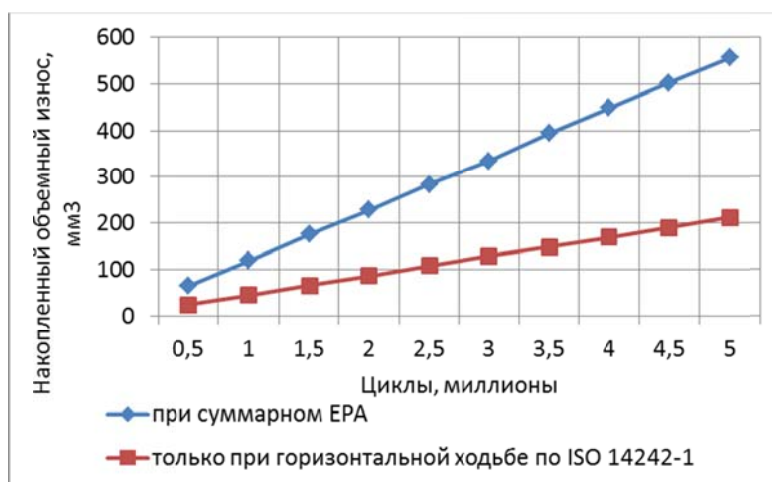
Рисунок 17 – Диаграммы накопленного объемного износа при суммарном EPA и только для горизонтальной ходьбы согласно ISO 14242–1 при той же длительности цикла, что и для EPA
