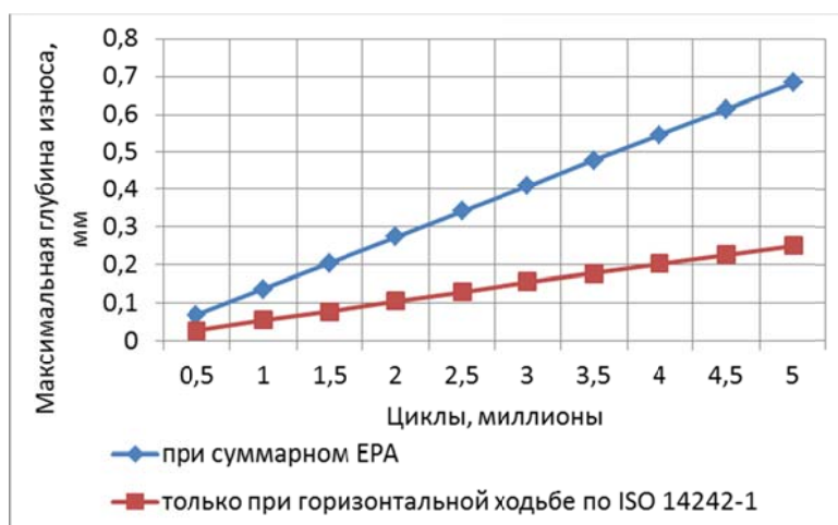
Рисунок 16 – Диаграммы линейного износа при суммарном EPA и только для горизонтальной ходьбы согласно ISO 14242-1 при той же длительности цикла, что и для EPA
