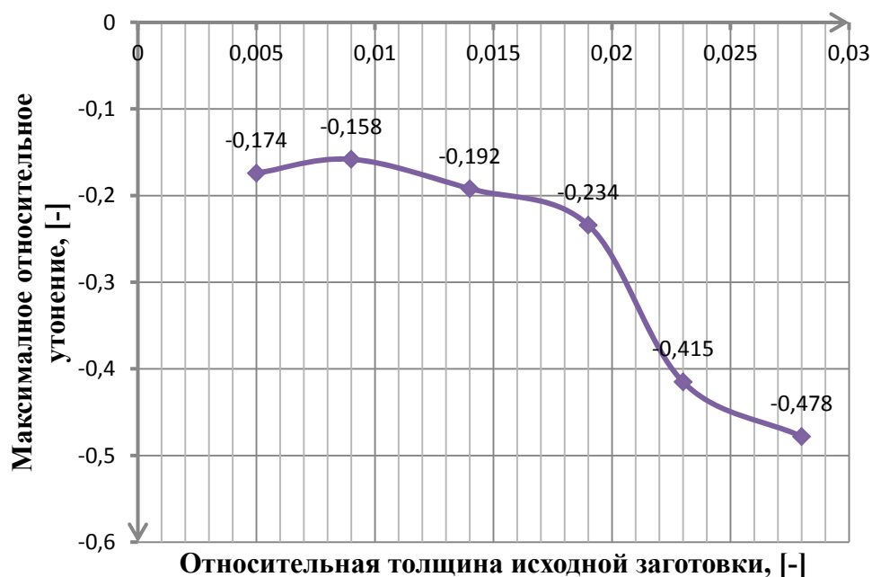
Рисунок 3 – График зависимости максимального относительного утонения полученной детали от относительной толщины исходной заготовки
