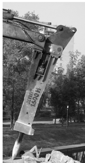
Рисунок 2 – Гидроударник фирмы "Раммер" с компенсацией отдачи посредством жестких пружин
