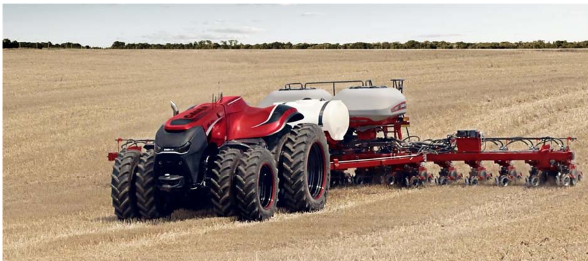
Рисунок 8 – Автономный трактор CaseIH с системой автоматического вождения и телематики
