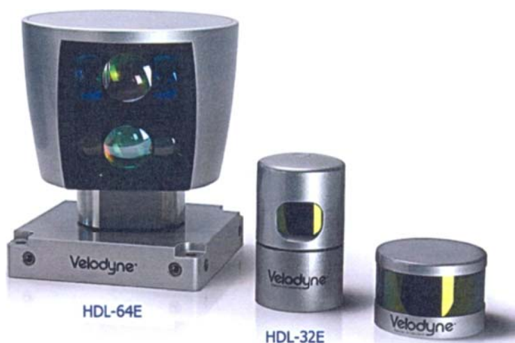
Рисунок 4 – Датчики кругового обзора 3D ЛИДАР Velodyne
