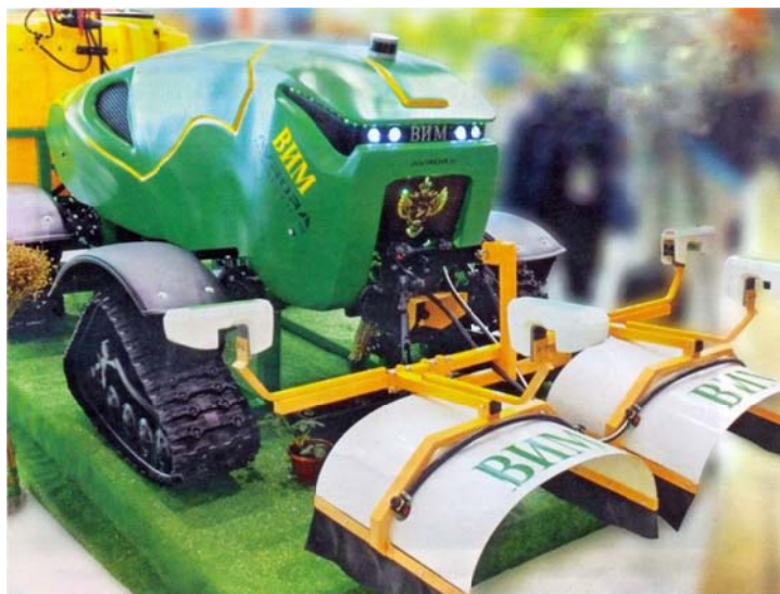
Рисунок 9 – Роботрак «ВИМ 0,6(0,9)–36» в агрегате с опрыскивателем для внесения в почву жидких минеральных удобрений
