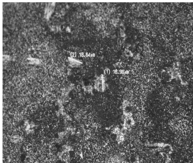
Рисунок 1 – Литая микроструктура ( \lambda ) и ( d_{\gamma/\gamma'} ) сплава ЖС32
