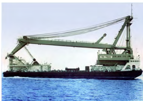
Рисунок 12 – Самоходный морской плавкран проекта 15201 грузоподъемностью 500 т
