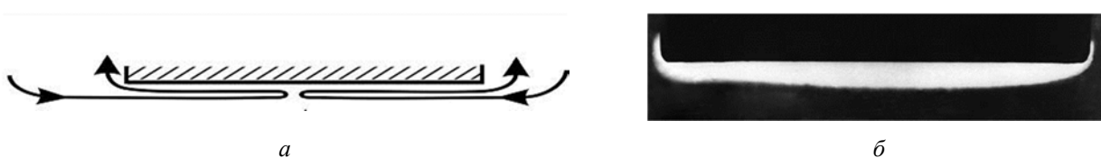
Рисунок 9 – Схема течения воды вдоль горизонтальной теплоотдающей поверхности а и визуализация прогретого слоя б
