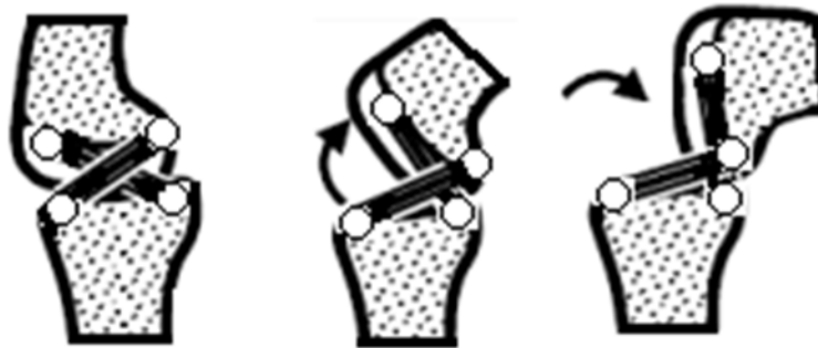
Рисунок 3 – Последовательные положения звеньев шарнирного четырехзвенника, моделирующего сгибание коленного сустава в сагиттальной плоскости
