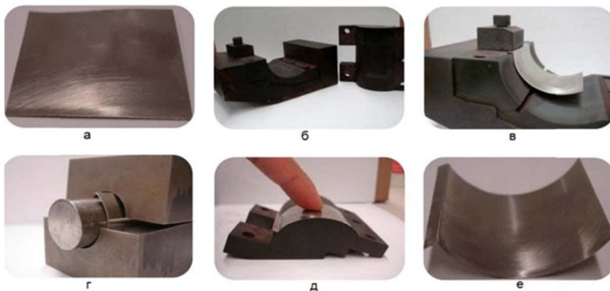
Рисунок 9 – Технологический процесс деформации лепестка:
