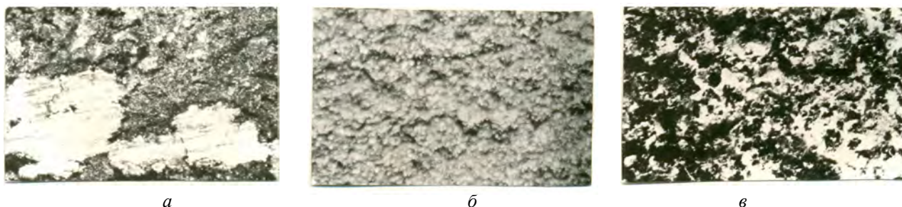
Рисунок 1 –Фотографии рабочей поверхности круга ЛО8 С1 100% С10 после шлифования стали Р9Ф5:
