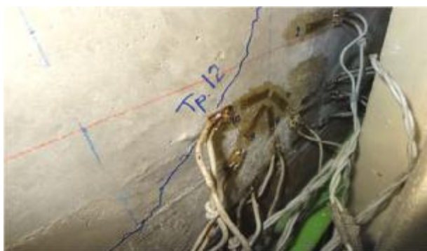
Рисунок 4 – Общий вид установки электротензорезисторов на бетон
