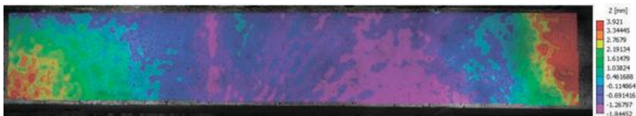
Рисунок 7 – Область анализа измерений прогибов ригеля системой VIC-3D
