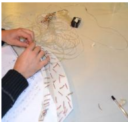
Рисунок 1 – Предварительная сборка измерительной системы, включающей в себя датчики давления (определение C_p )
