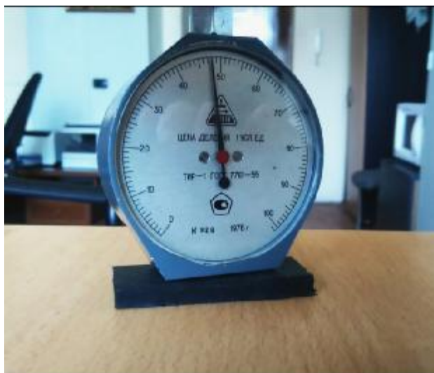
Рисунок 1 – Определение твердости по Шору уплотняющей прокладки для структурного остекления фасадов
