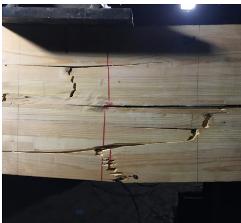
Рисунок 6 – Разрушение образца из-за разрыва волокон древесины
