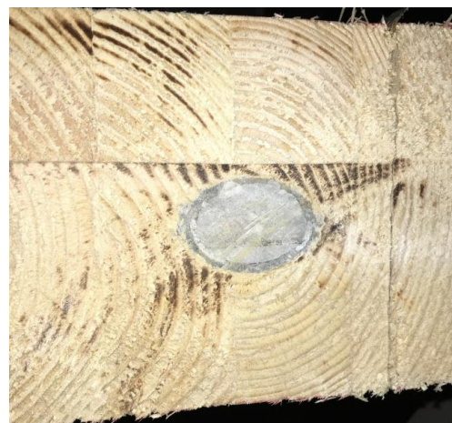
Рисунок 7 – Клеевое соединение стержня и древесины после испытаний
