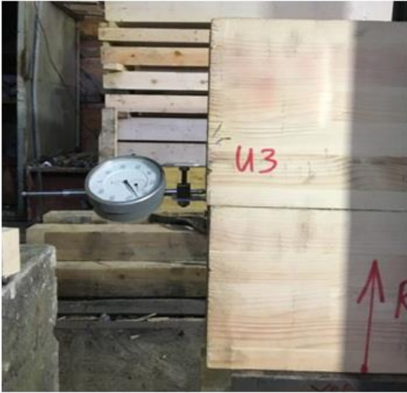
Рисунок 4 – Сдвиговые деформации на торце конструкции
