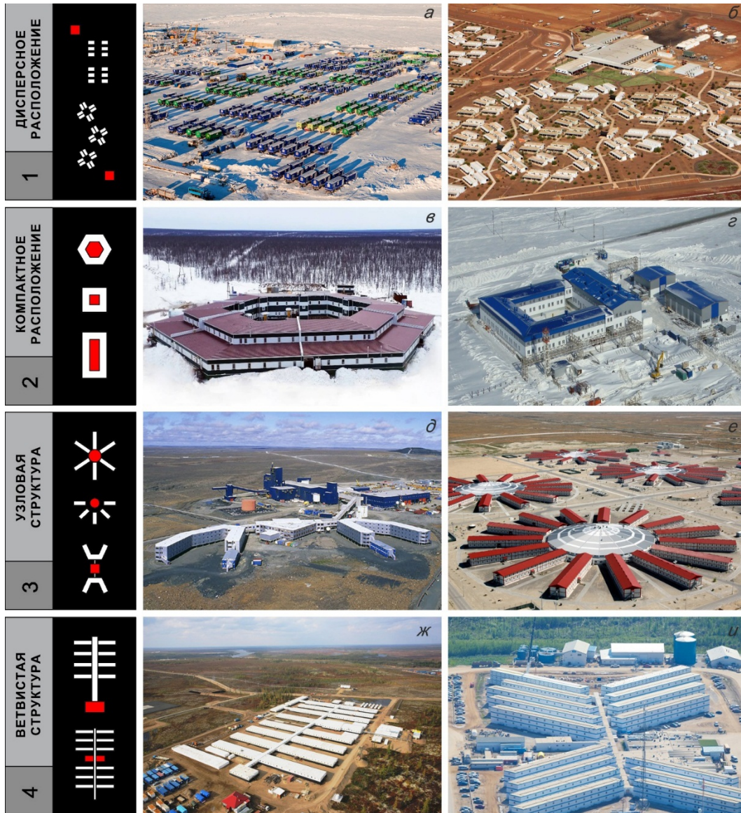
Рисунок 5 - Варианты компоновки элементов жилого назначения и блока культурно-бытового обслуживания при формировании застройки вахтового поселка. 1 – дисперсное расположение; 2 – компактное расположение; 3 – узловая структура; 4 - ветвистая структура; а – вахтовый поселок возле газового месторождения Бованенковское в Ямало-Ненецком АО; б – общий вид вахтового поселка при рудном месторождении Citic Pacific в Австралии; в – вахтовый комплекс алмазодобытчиков на 400 человек при месторождении Эбелях-Гусиный в Якутии; г – вахтовый поселок Варандей на 180 человек при нефтяном терминале компании Лукойл в Ненецком АО; д – вахтовый поселок Raglan при никелевом руднике на Севере Канады; е – проектное предложение по организации рабочего поселка Шанырак на 8000 человек в Атырауской области Казахстана; ж – вахтовый поселок на 1200 человек при Ванкорском нефтяном месторождении в Красноярском крае; и – вахтовый поселок нефтяного месторождения Beaver River Executive Lodge в Канаде
