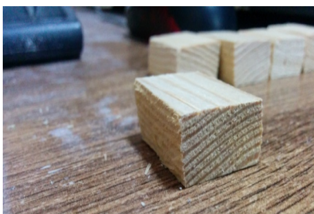
Рисунок 7 – Разрушенный образец при сжатии в радиальном направлении
