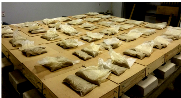
Рисунок 5- Загрузка СПБ распределенной нагрузкой на элементы покрытия
