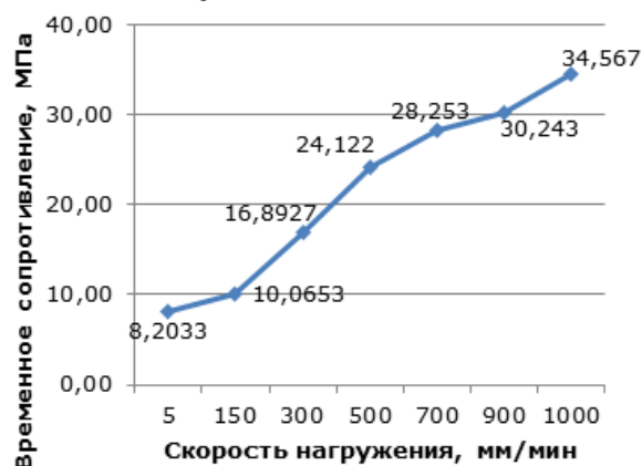
Сжатие поперек волокон тангенциально
