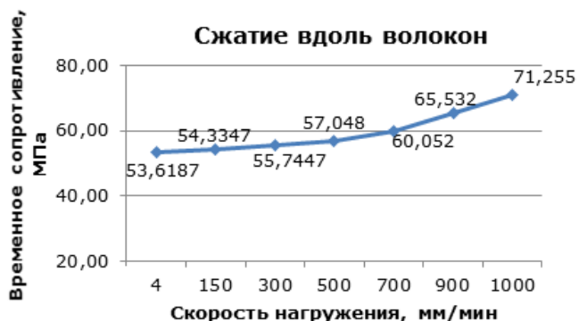
Рисунок 2 – Диаграмма зависимости величины временного сопротивления древесины сосны вдоль волокон от скорости нагрузки
