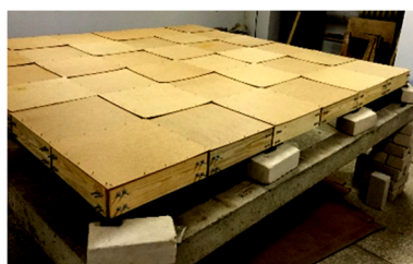
Рисунок 1– Конструкция СПБ с элементами покрытия (а) и узел крепления элементов (б)
