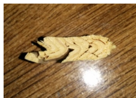
Рисунок 10 – Характер разрушения образцов при сжатии поперек волокон тангенциально
