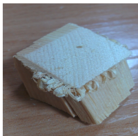
Рисунок 4 – Характер разрушения образцов при сжатии вдоль волокон
