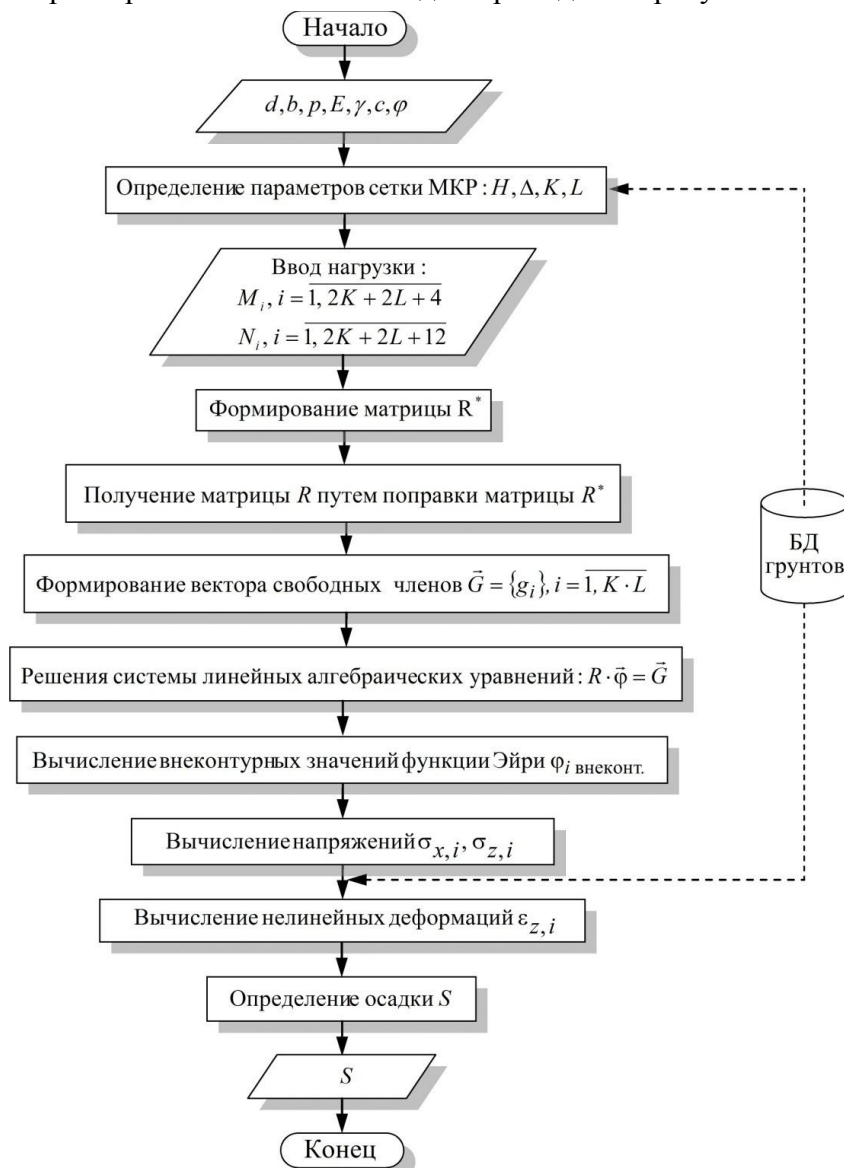
Рисунок 7 – Общий алгоритм расчёта конечной осадки по МКР
