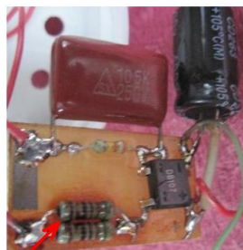
Одна из возможных причин отказа – перегрев резисторов в цепи электропитания
