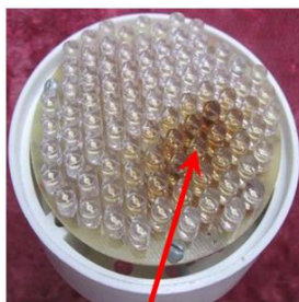
Результат работы светодиодной лампы в условиях постоянного перегрева
