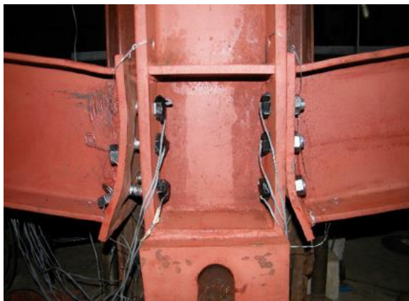
Рисунок 2 – Общий вид испытаний узлов соединения стальных конструкций
