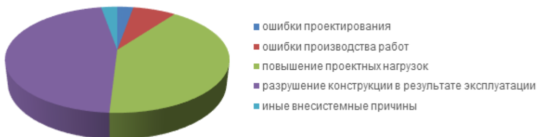
Рисунок 5- Распределение причин необходимости усиления/восстановления строительных конструкций мостовых сооружений
