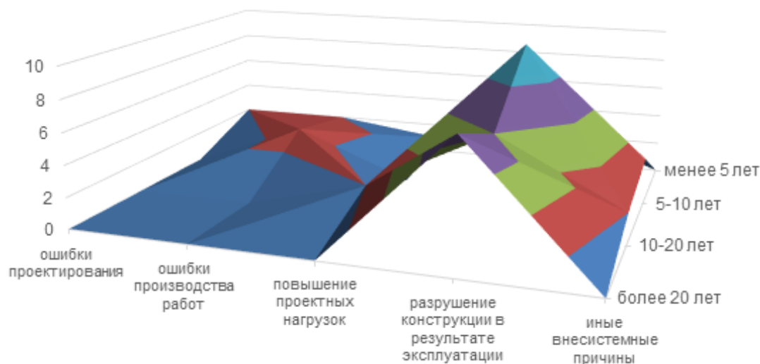
Рисунок 4- Распределение причин необходимости усиления/восстановления строительных конструкций специальных зданий и сооружений по годам
