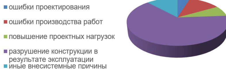
Рисунок 3- Распределение причин необходимости усиления/восстановления строительных конструкций специальных зданий и сооружений
