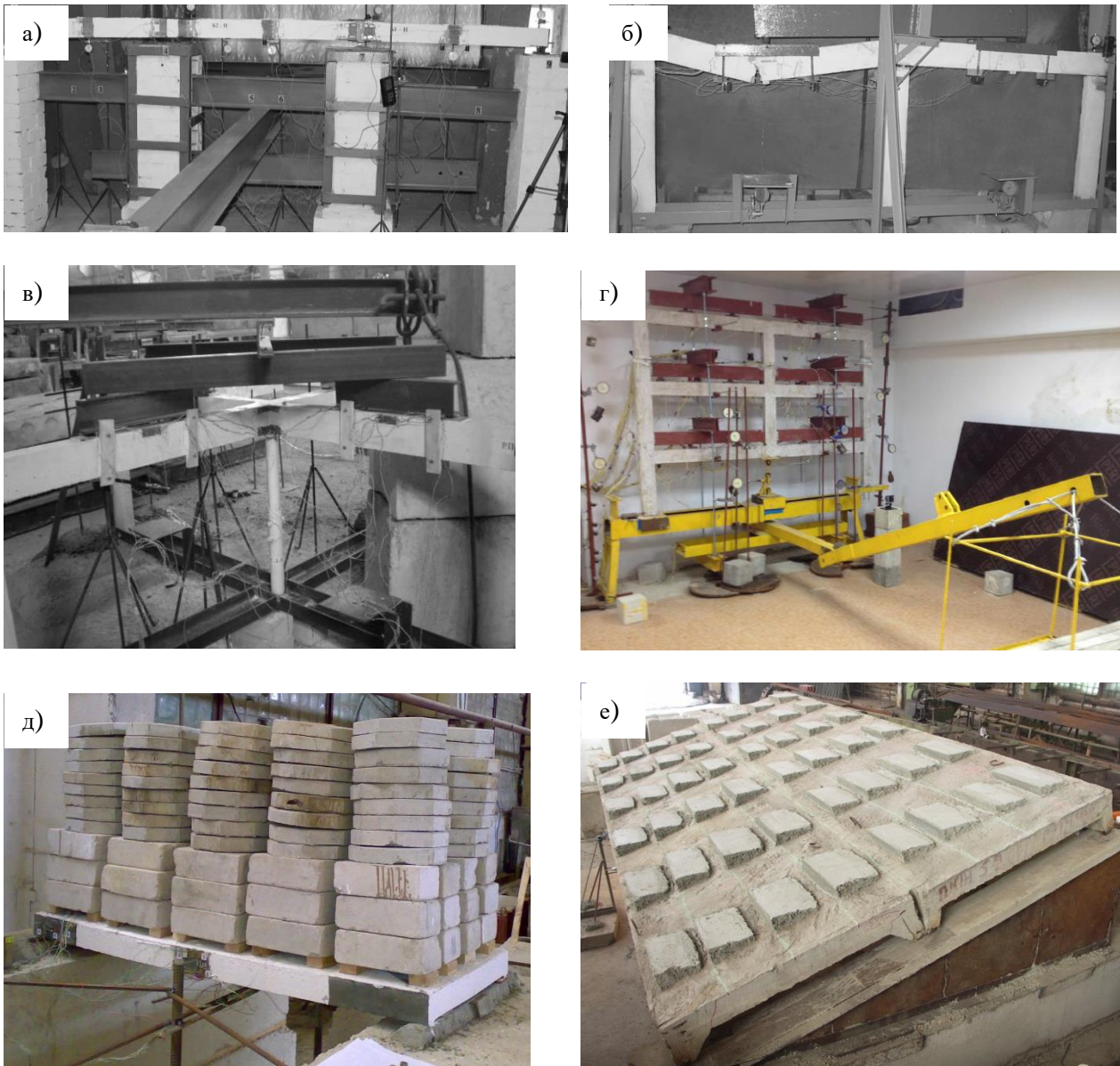
Рисунок 3 – Экспериментальные исследования железобетонных конструкций в России при аварийных воздействиях - общий вид испытаний: многопролетных балочных конструкций сплошного и составного сечения (а); плоских рамно-стрессневых конструкций сплошного и составного сечения, в том числе с преднапряженным ригелем (б); многоэтажной монолитной рамно-стержневой конструктивной системы (в); фрагмента пространственной рамно-стержневой конструкции (г); модели ребристой плиты (д) и фрагмента призматической складки (е)
