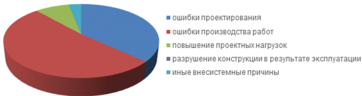
Рисунок 7- Распределение причин необходимости усиления/восстановления строительных конструкций малоэтажных зданий
