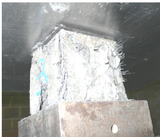
Рисунок 1 – Кубический образец после разрушения
