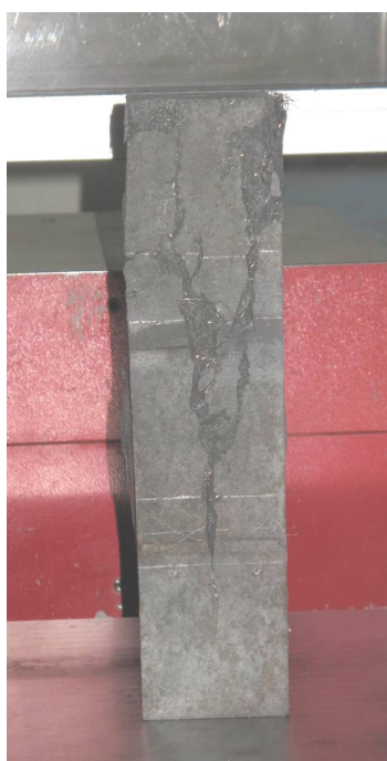
Рисунок 2 – Призмический образец после разрушения
