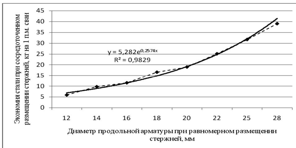
Рисунок 2 – График экономии арматуры при увеличении диаметра продольных стержней с линией тренда (пунктиром обозначен график экономии стали при сосредоточенном размещении арматуры по данным вычислений, сплошной линией обозначен график экономии стали при сосредоточенном размещении арматуры на основании уравнений регрессии)
