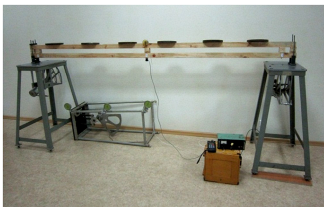
Рисунок 3 – Установка для испытания балок
