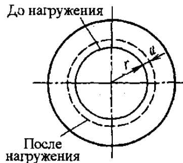
Рисунок 4 – Длина окружности, проведенной внутри цилиндра до и после его нагружения (до и после поврежденности арматуры коррозией)
