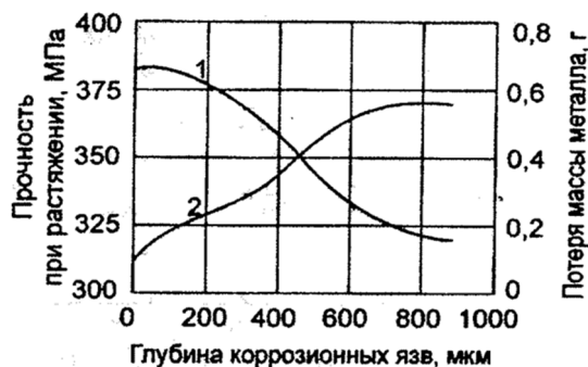
Рисунок 2 – Зависимости прочности при растяжении арматуры и потери массы металла от глубины коррозионных язв: 1 – прочность при растяжении; 2 – потеря массы металла
