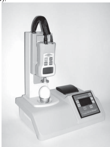
Рис. 2. Измеритель прочности скорлупы яйца (Egg Force Reader).
