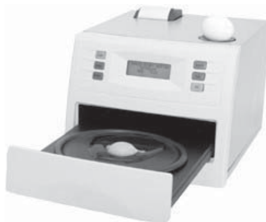
Рис.3. Анализатор качества яйца (Egg Analyzer).
