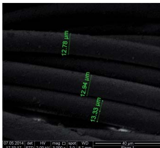
Рис. 13. Измерение диаметра волокон сосудистого импланта производства фирмы «Линтекс» при электронной растровой микроскопии, ув. 3000х.
