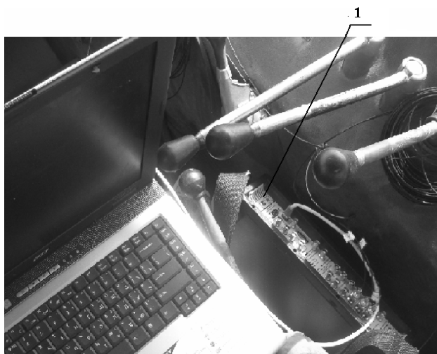
Рис. 2. Экспериментальные замеры: 1 – прибор Bluel&Kjaer акселерометр типа 4507 001.
